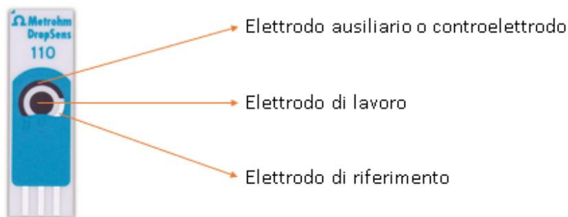
Figura 2.9 Un esempio del sensore serigrafato a tre elettrodi prodotto da Metrohm DropSens. Il substrato utilizzato è costituito da un materiale ceramico (3,4 x 1,0 x 0,05 cm) con elettrodo di lavoro in carbonio (area 0,11 cm<sup>2</sup>), un elettrodo di riferimento in argento e un contro-elettrodo in carbonio. In basso vengono mostrate anche le connessioni di uscita.
