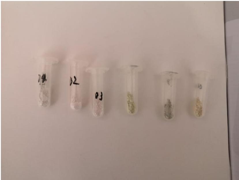
Figura 2.4 Campioni ottenuti con diverse quantità di NaOH
