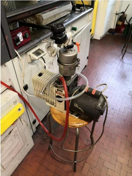
Figura 2.3 Strumento per eseguire la filtrazione sottovuoto
