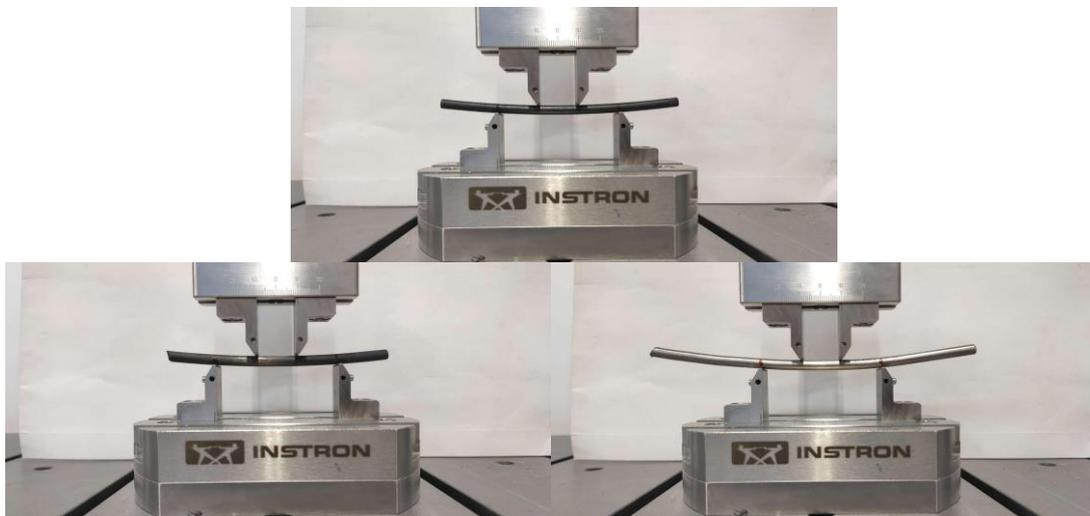
Figura 2.3 Prova di flessione a quattro punti sulle tre barre
