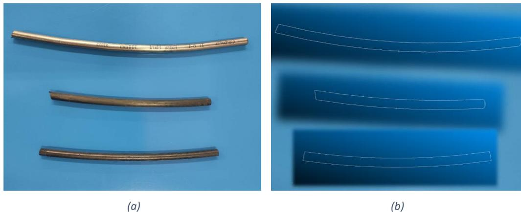
Figura 2.5 Confronto geometria barre (a) reali e (b) ricostruite tramite software
