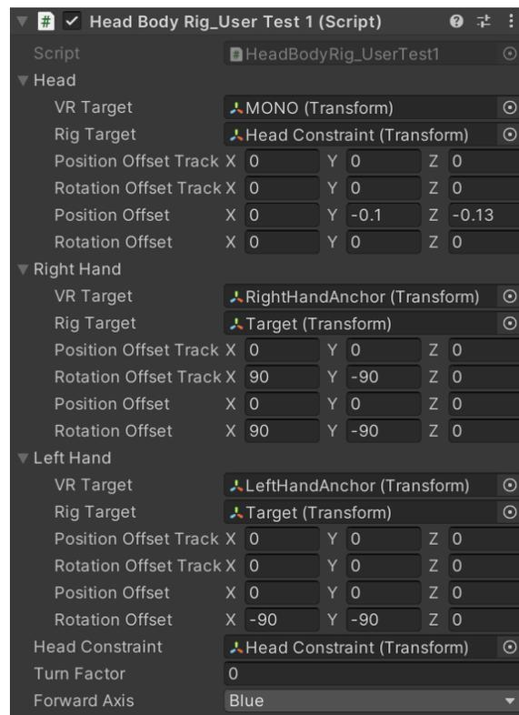
Fig. 66 Head Body Rig: i VR Target sono le componenti VR di testa e mani, i Rig Target sono i constraints creati in fase di setup.
