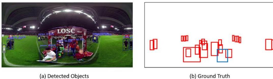
Fig. 43 Un esempio ottenuto con un algoritmo di object detection basato su YOLO [38]: una persona, indicata in blu, non è stata rilevata. - Immagine presa dal paper in questione
