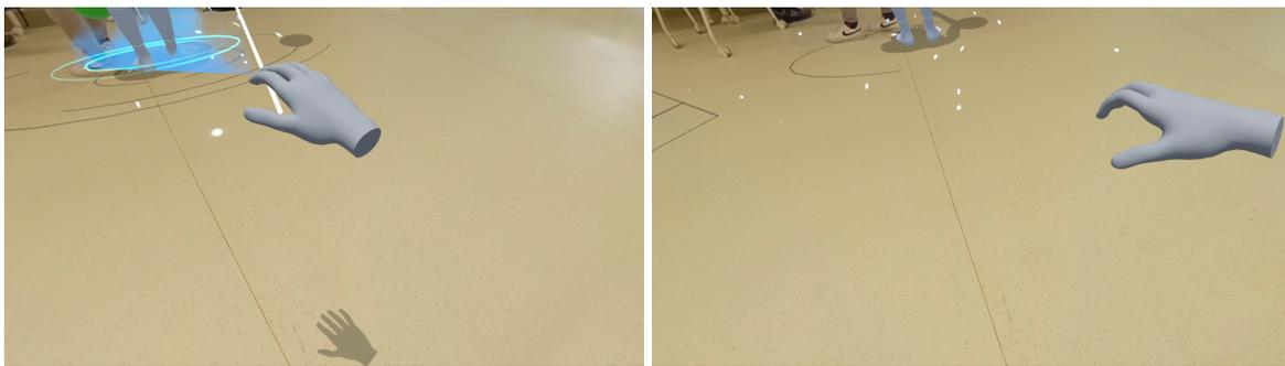
*Fig. 60 A sinistra l'approccio a camera singola (con il modello della mano sullo stesso layer Background del Floor); a destra l'approccio a camera doppia (il modello della mano si trova sul layer Objects mentre il Floor su Background): da notare l'assenza dell'ombra sul pavimento.*
