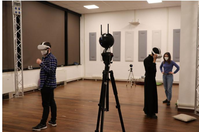
*Fig. 16 Il set-up della Fase 3: i due spettatori esplorano l'ambiente virtuale indossando l'HMD. Sono già presenti le camere 360° per la fase successiva.*
