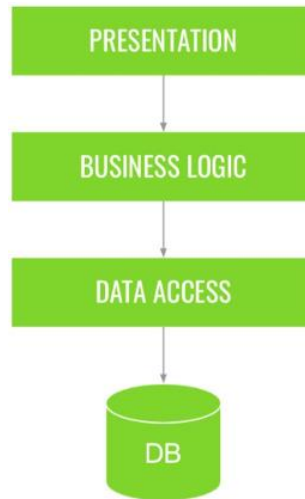
Figura 1 - Modello dell'architettura a strati utilizzato per rappresentare la struttura di un monolite.
