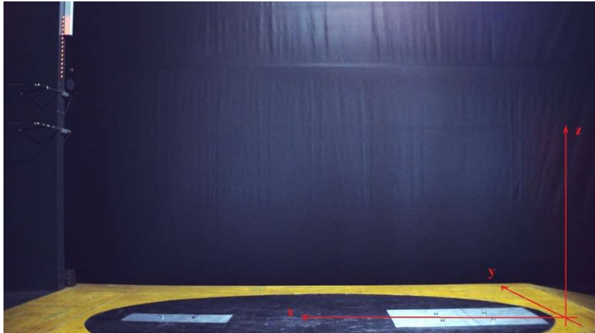
Figura 4.14 Sistema di riferimento cartesiano nella galleria "R.Balli"
