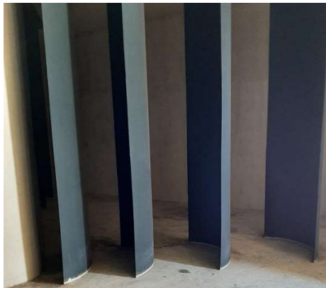
Figura 4.2 Corners della Galleria del Vento "R.Balli"
