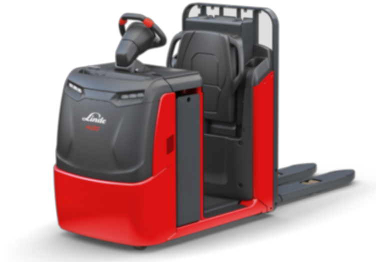
Figura 3.11: Carrello commissionatore usato per il picking delle batterie
