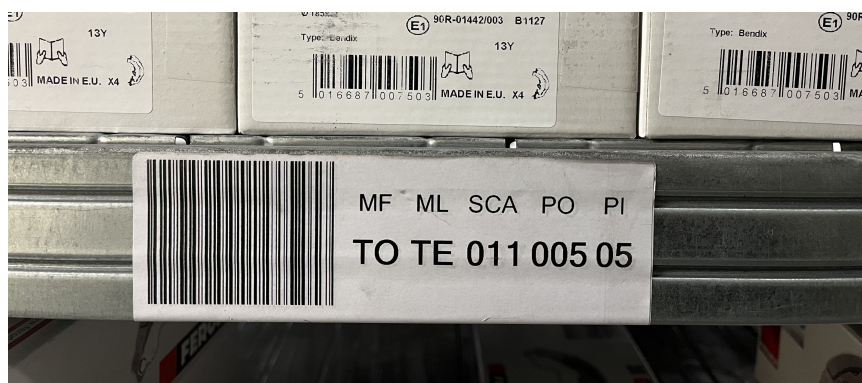
Figura 3.17: Esempio di etichetta che contrassegna un'ubicazione
