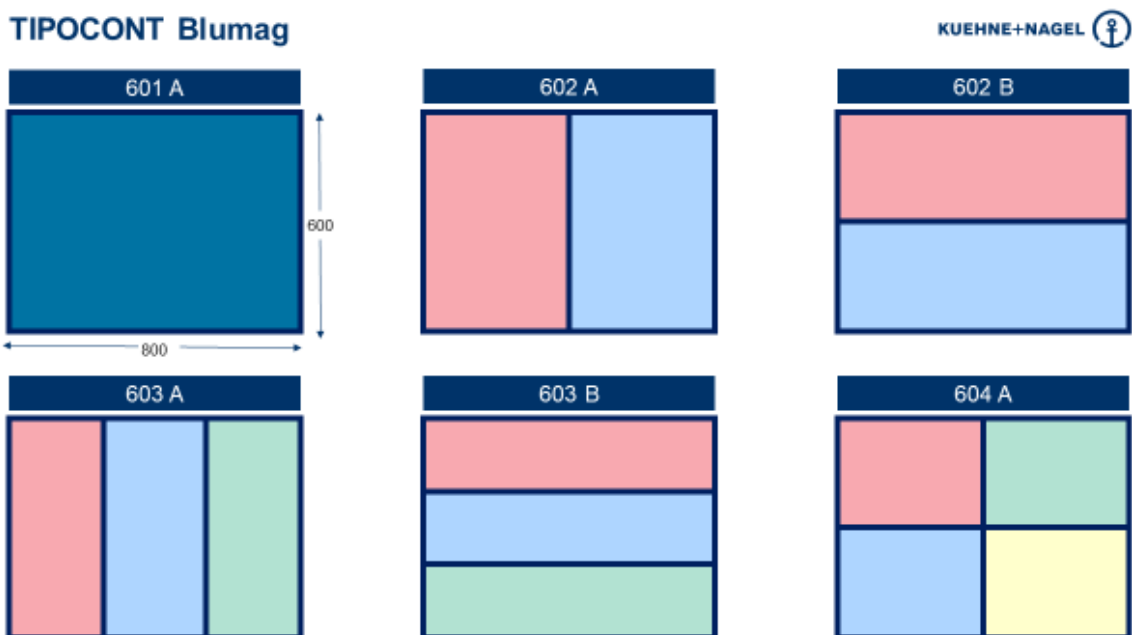
Figura 32: Tipologie di scomparti in cui suddividere le odette del BLUMAG
