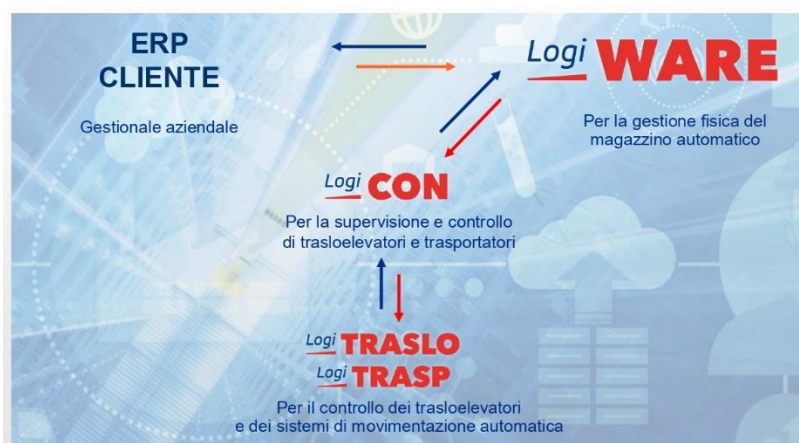
Figura 34: Tipologia e relazione dei vari sistemi di gestione del magazzino automatizzato BLUMAG
