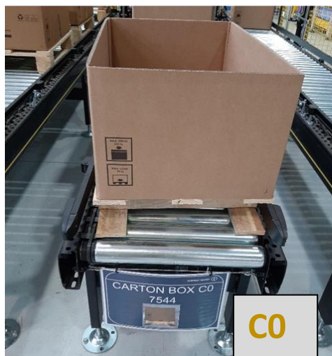
Figura 115: Codici imballo A0, B0, C0, C1 (Carton-Box) collocati sulle rispettive rulliere di asserimento
