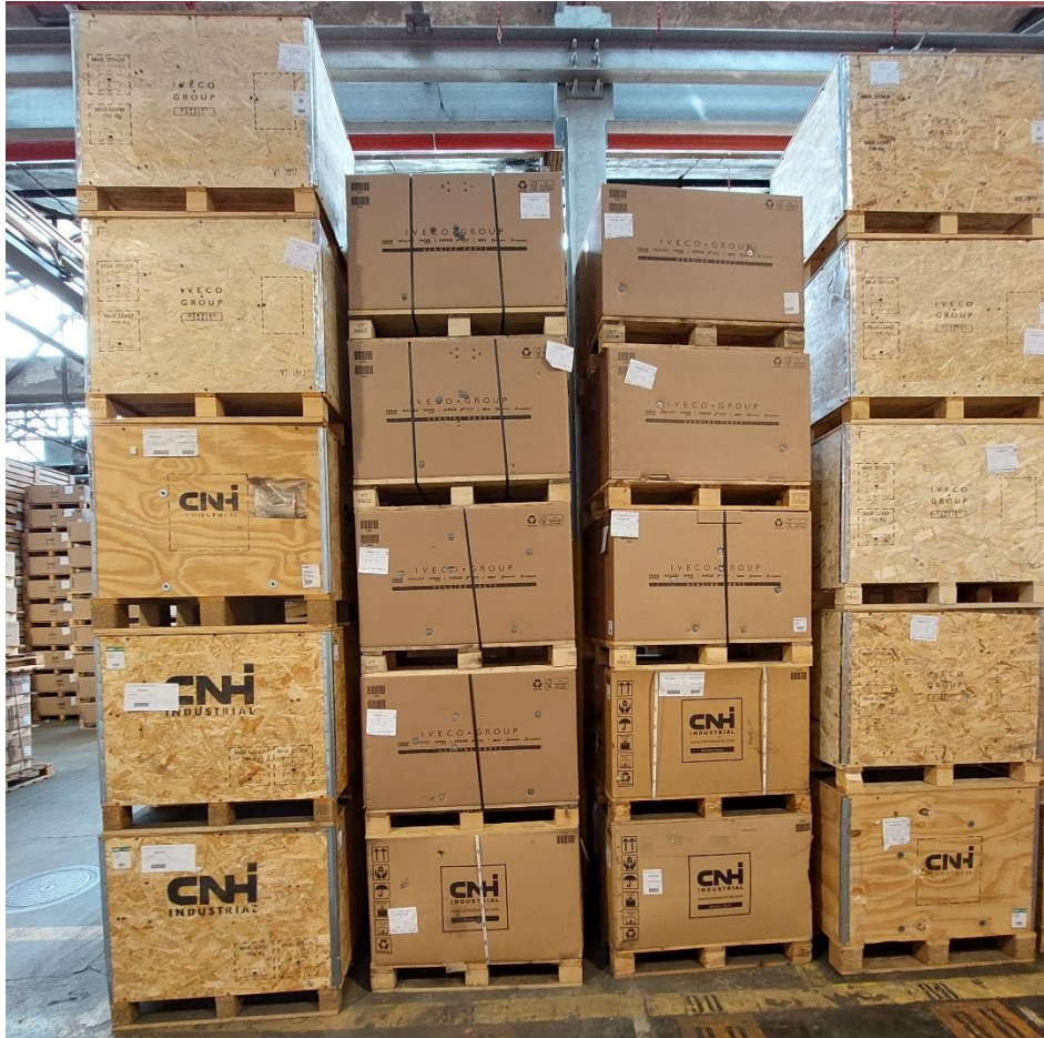
Figura 91: Impilamento a catasta nel magazzino SCR (Parte 1)
