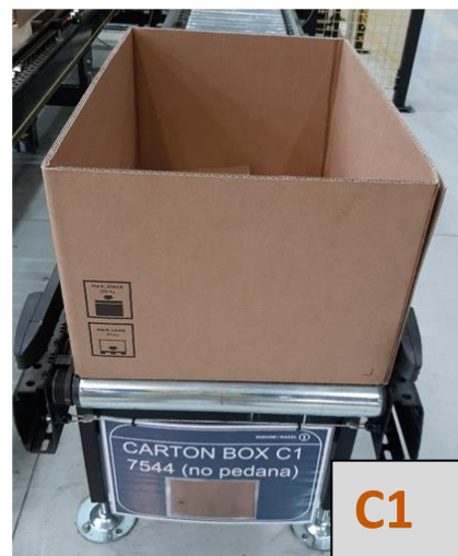
Figura 115: Codici imballo A0, B0, C0, C1 (Carton-Box) collocati sulle rispettive rulliere di asserimento
