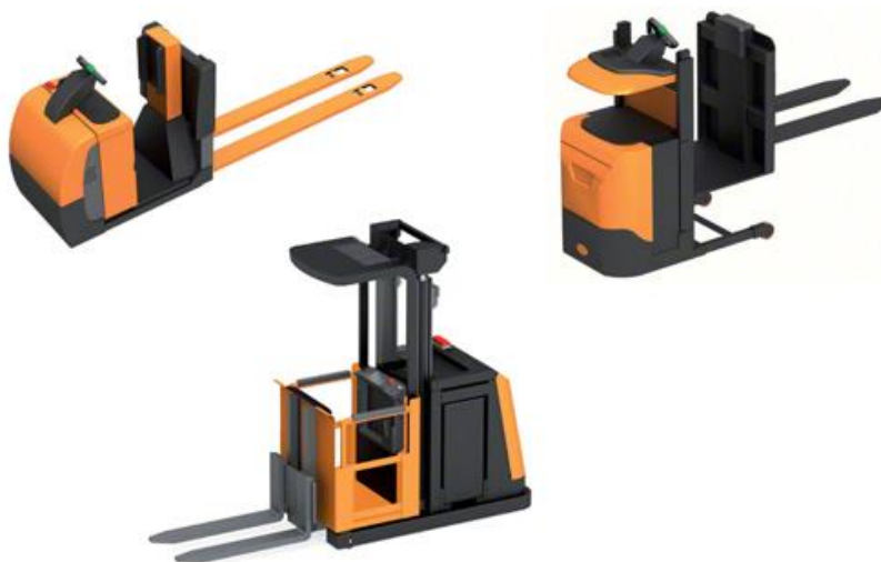
Fig. 1.10 - Carrello commissionatore a terra (sinistra); per bassi livelli (destra); per medi/alti livelli (centro) – Fonte: Mecalux
