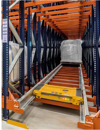
Fig. 1.8 - Scaffalatura con sistema pallet shuttle
