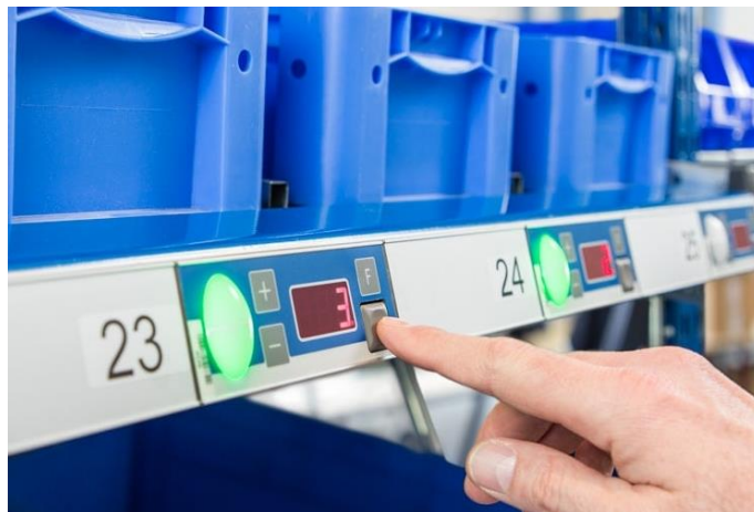
Fig. 4.3 - Esempio di sistema Pick To Light – Fonte: Luca Logistic Solutions
