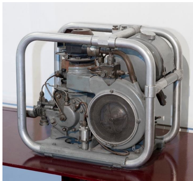
Figura 3.4 – Motore Stirling prodotto da Philips nel 1952
