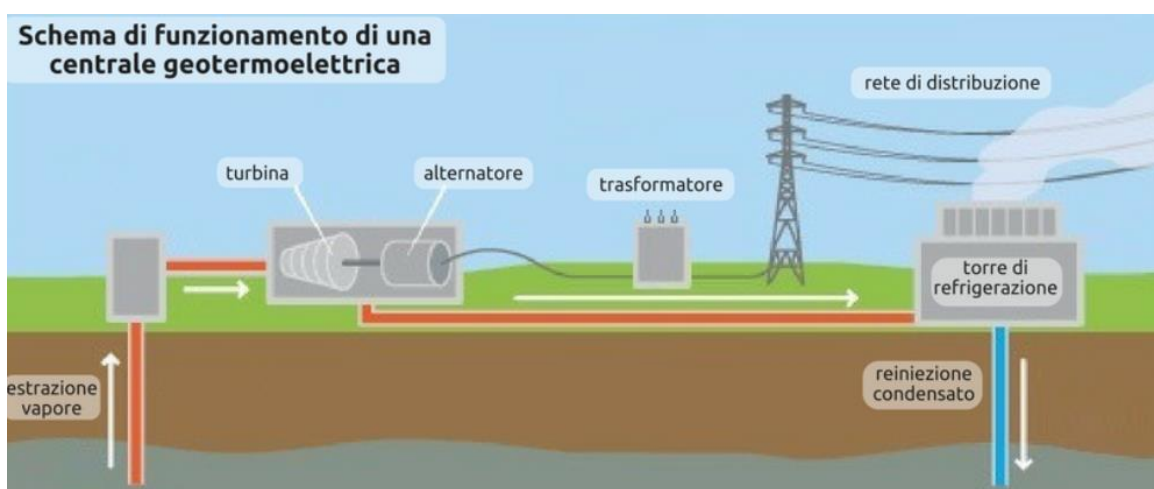
Figura 7 Esempio impianto generazione elettrica da geotermico
