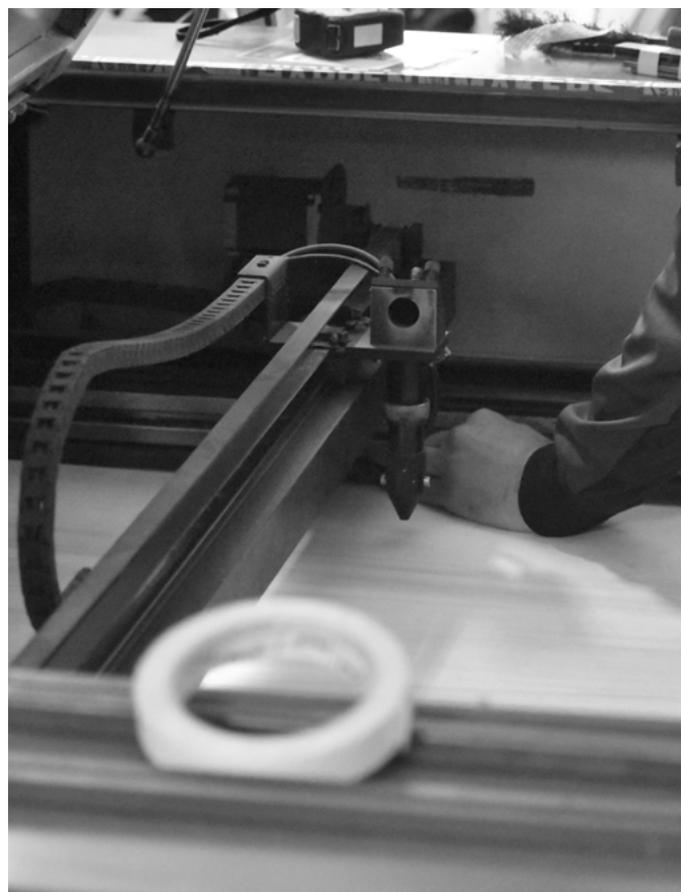
Fig.25: Lavorazione di pannelli multistrato con laser cutter durante il corso di Design by Components 2021/2022, FabLab Torino. Foto di proprietà dell'autore
