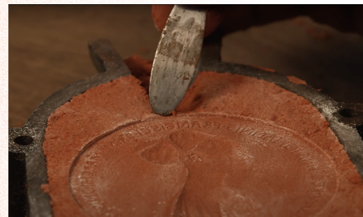
6 SCAVARE NELLO STAMPO I CANALI DOVE VERRÀ COLATO IL METALLO FUSO
