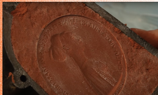
5 RIMOZIONE MODELLO IN CERA, OTTENENDO IL NEGATIVO
