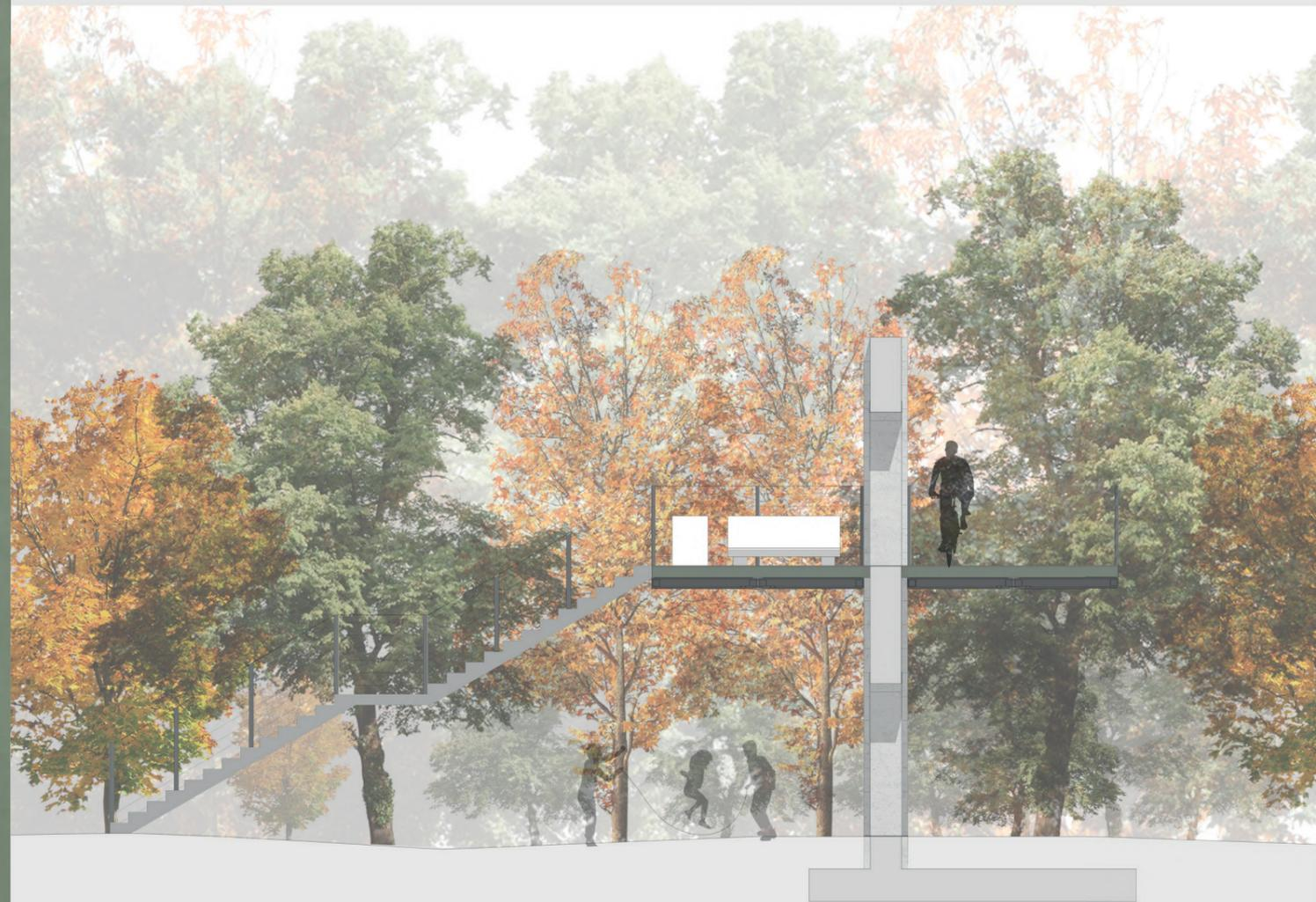
Rappresentazione sezione tipologica modulo a 3 luci con scala di discesa
