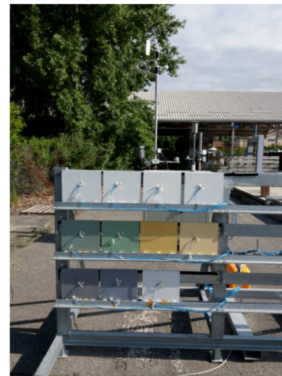
Fig.1 Mattonelle di prova realizzate in laboratorio con cool materials cementizi.
