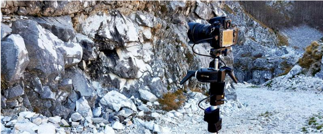
Fig. 15: Strumento per la realizzazione di un rilievo fotogrammetrico terrestre
