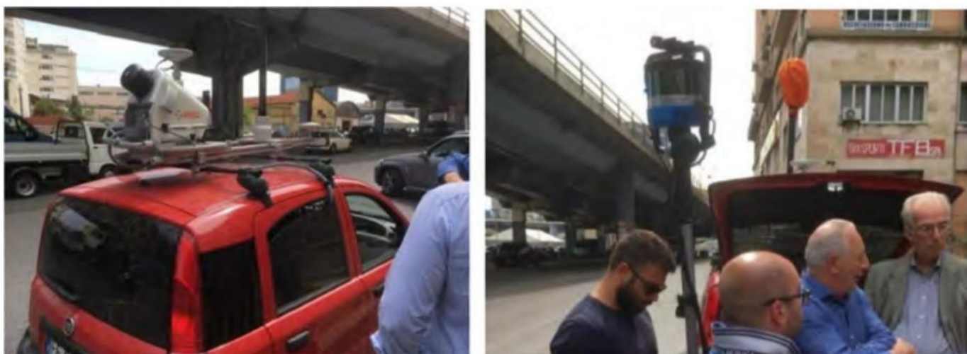
Fig. 31: Sensore LiDAR Riegler Vux 1 su auto e scanner statico Leica a piedi
