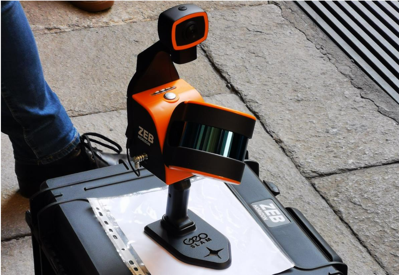
Fig. 20: Strumento Geo SLAM - ZEB Horizon RT presso il Palazzo del Rettorato, Torino
