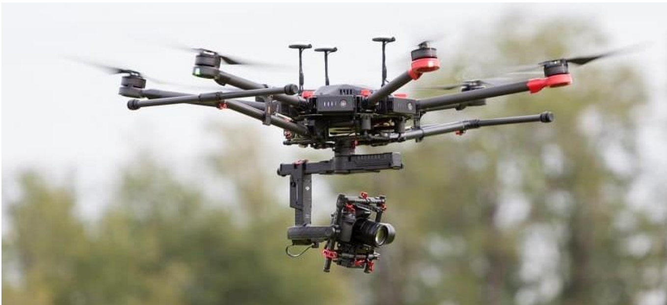
Fig. 16 Strumento per la realizzazione di un rilievo fotogrammetrico aereo
