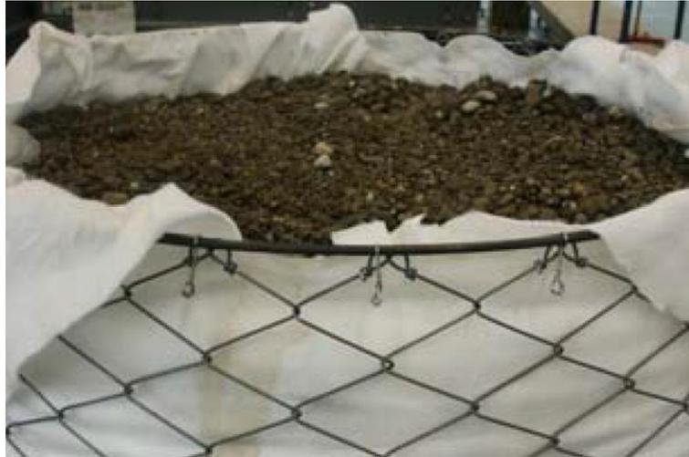
Figura 4.16: Foto raffigurante le modalità d'uso del materiale utilizzato negli esperimenti con strato assorbente (Schellenberg et al., 2006).
