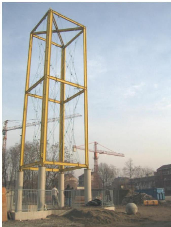
Figura 4.19: Struttura per il sollevamento del blocco utilizzata negli esperimenti del Politecnico di Milano (Calvetti & Prisco, 2007).
