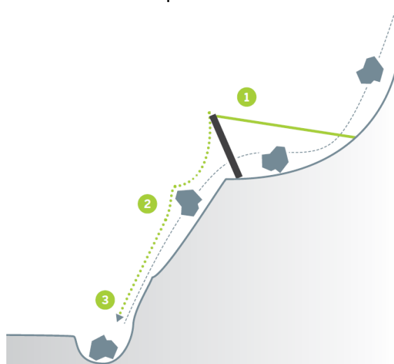
Figura 28 Individuazione delle differenti zone di transito. (immagine da catalogo GEOBRUGG) (27)
