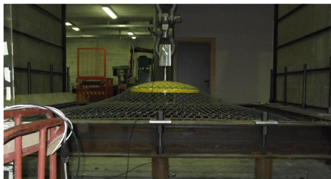
Figura 35 Vista laterale di una prova di punzonamento standard UNI (Officine Maccaferri Spa) (11)
