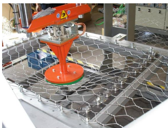
Figura 77 Esempio di macchina per il punzonamento (35)
