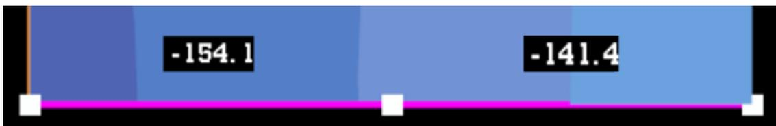
**Figura 4.14** Base della parete limitata tra i vertici 1 e 2, carico sismico agente lungo X, tensioni longitudinali in  $\left[\frac{daN}{cm^2}\right]$
