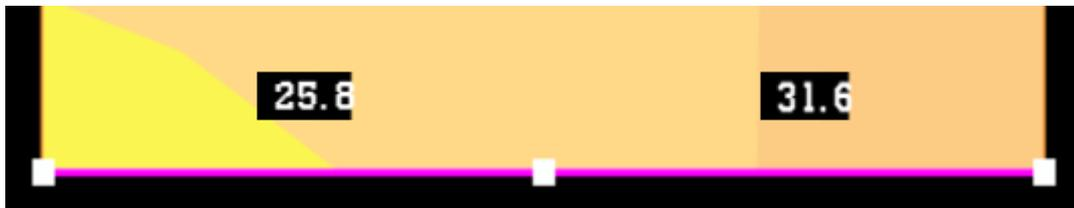
**Figura 4.15** Base della parete limitata tra i vertici 2 e 3, carico sismico agente lungo X, tensioni tangenziali in  $\left[\frac{daN}{cm^2}\right]$
