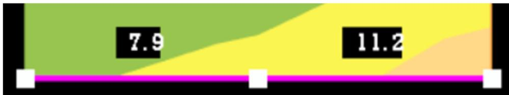
**Figura 4.9** Base della parete limitata tra i vertici 2 e 3, carico del vento agente lungo X, tensioni tangenziali in  $\left[\frac{daN}{cm^2}\right]$
