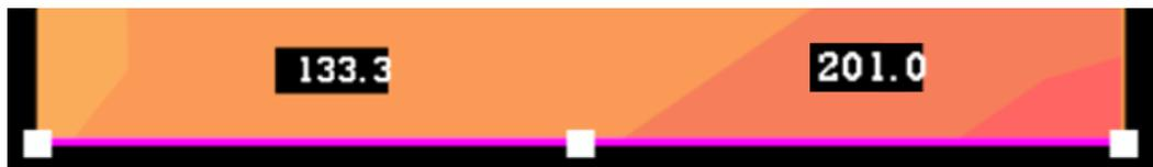
Figura 4.16 Base della parete limitata tra i vertici 8 e 9, carico sismico agente lungo Y, tensioni longitudinali in  $\left[\frac{daN}{cm^2}\right]$
