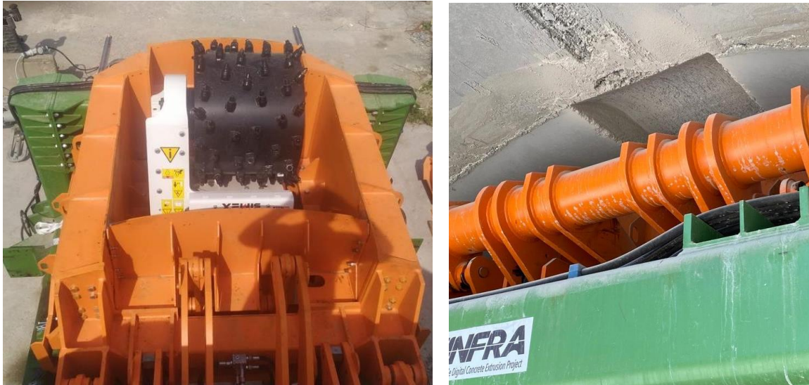
Figura 3-9: Fresa a tamburo per rimozione dello strato ammalorato.
