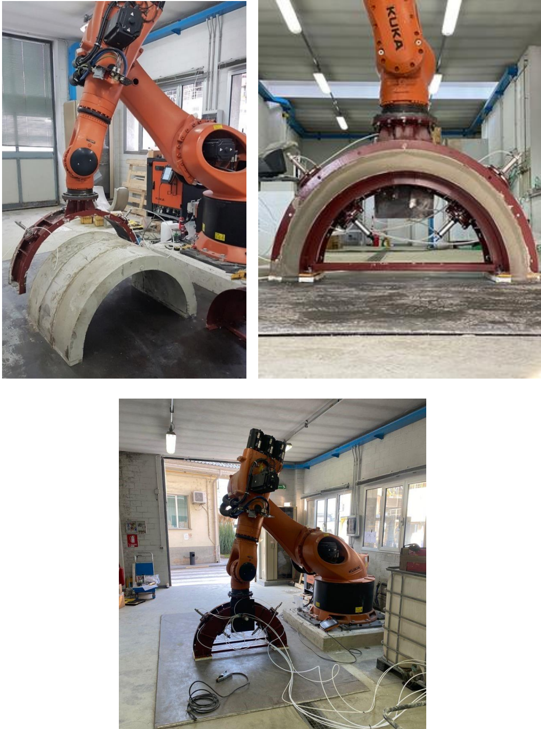
Figura 3-4: Laboratorio di estrusione in piccola scala – slipforming orizzontale.
