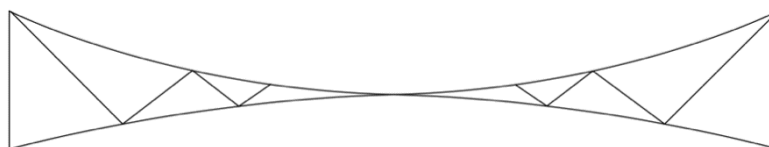
Figura 43: Schema simmetrico con collegamento in mezzeria tra la fune portante e quella stabilizzante
