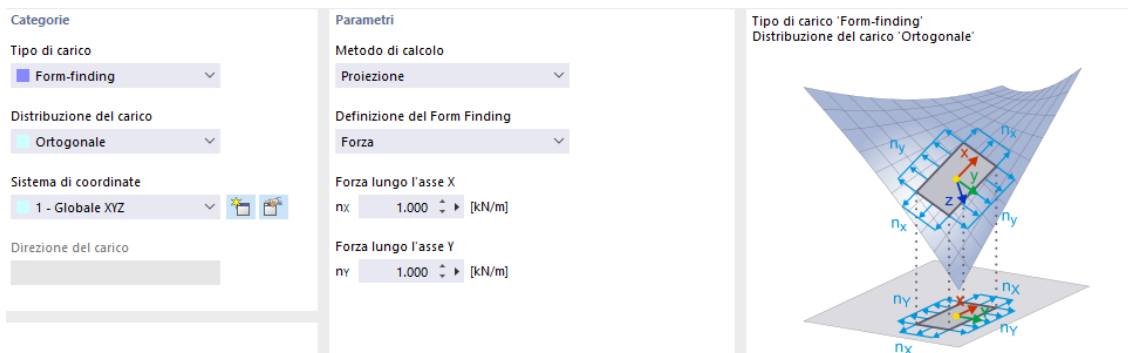
Figura 57: Processo di definizione dei carichi delle superfici
