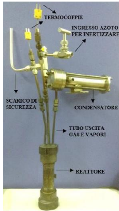
Figura 19: Impianto di pirolisi (Fonte: DISAT Polito)
