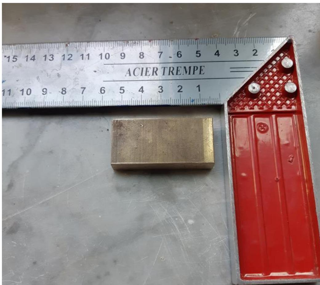
*Figura 14 - Spessori per garantire in fissaggio del provino per l'esecuzione della prova 4PB*
