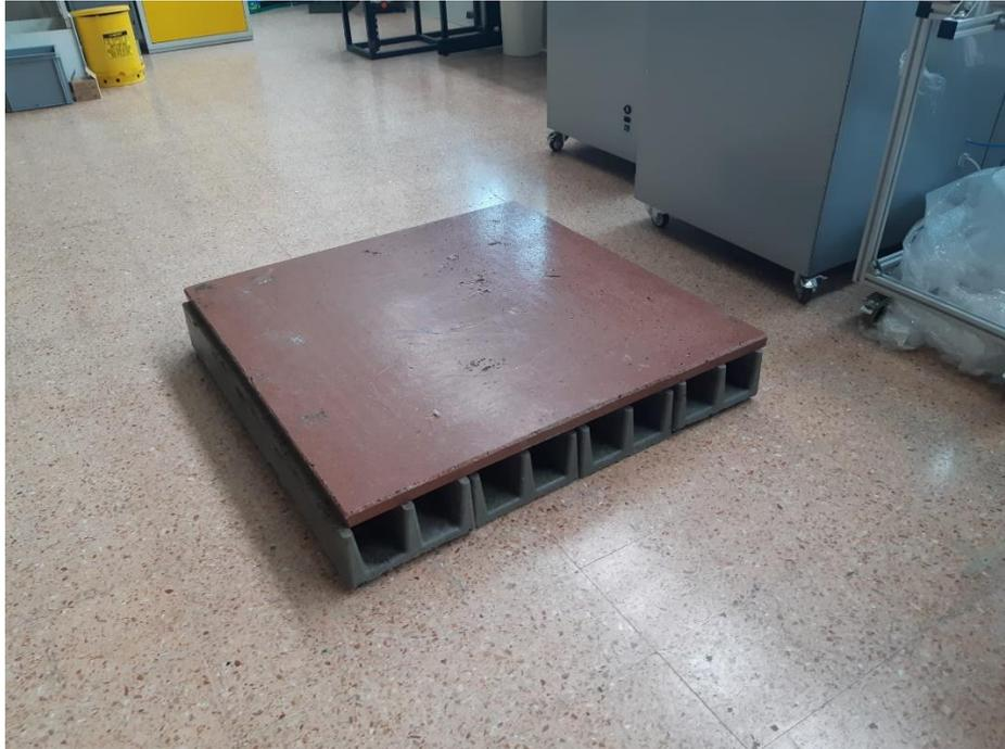
*Figura 42- Immagine del Modulo prefabbricato (4 travetti e una piastra)*
