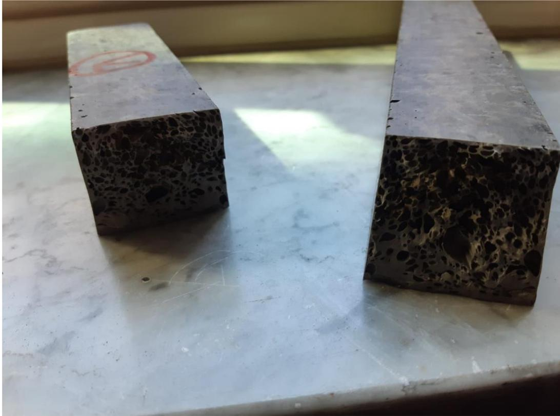
*Figura 9 - Sezione 1 Provino prismatico costituito da fresato (RAP) e Polipropilene (PP)*
