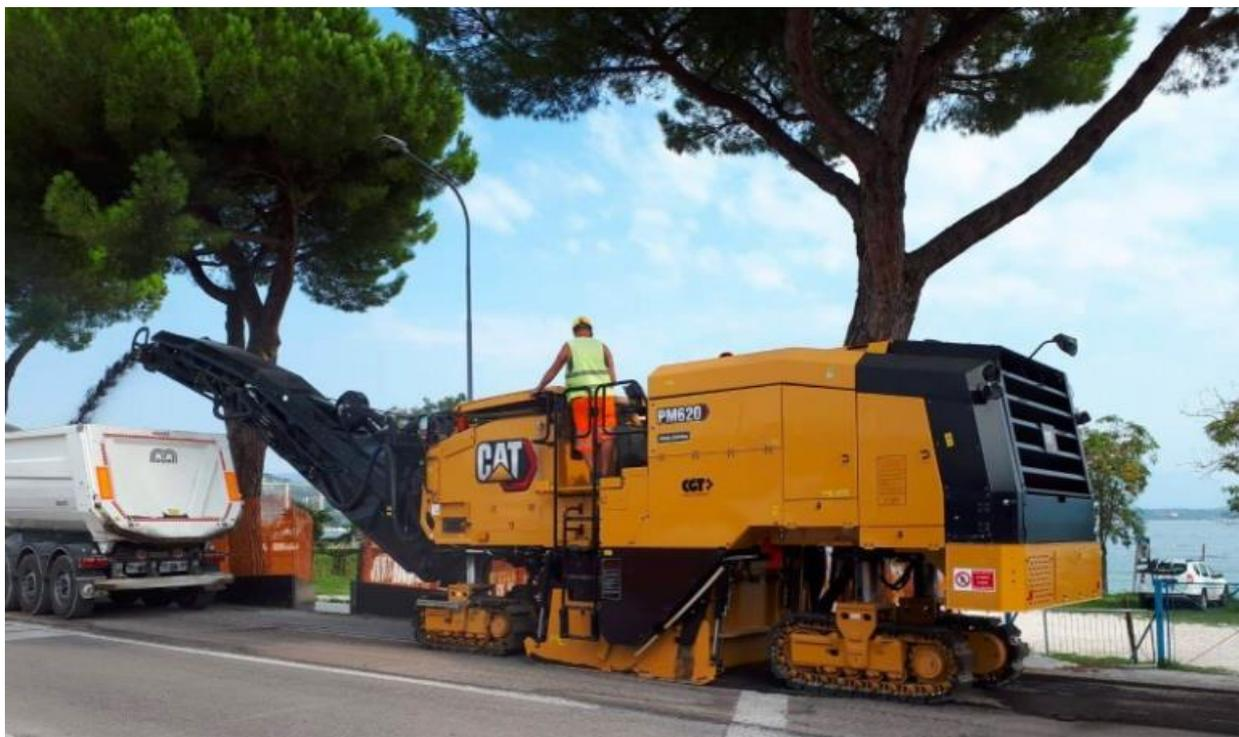
*Figura 5 - Macchina fresatrice*
