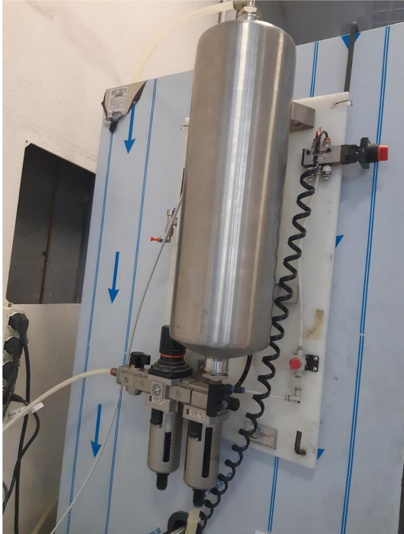
*Figura 16 - Particolare 1, Bombola ad aria compressa*
