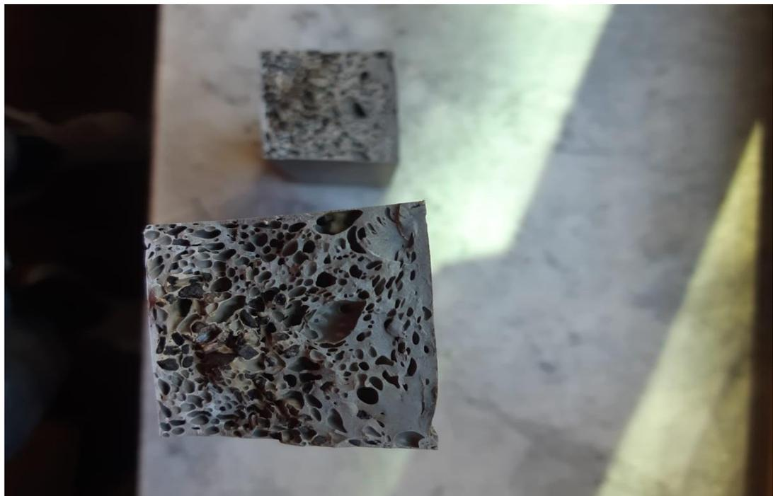
*Figura 10 - Sezione 2 provino prismatico costituito da fresato (RAP) e Polipropilene (PP)*
