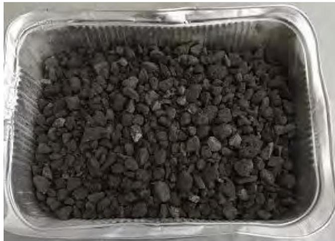
*Figura 32 - Fresato pezzatura 0/22,4 mm*
