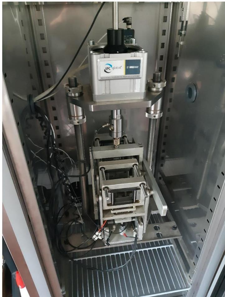
*Figura 19 - Accessorio per Four Point Bending Test*
