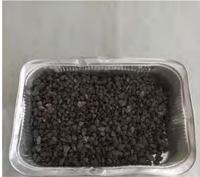
*Figura 31 – Fresato pezzatura 0/14 mm*
