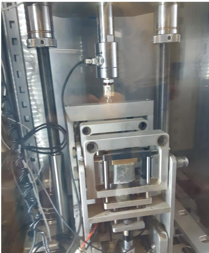
*Figura 20 - Posizionamento provino nella macchina*
