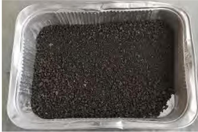
*Figura 33 - Fresato pezzatura 0/4 mm*
