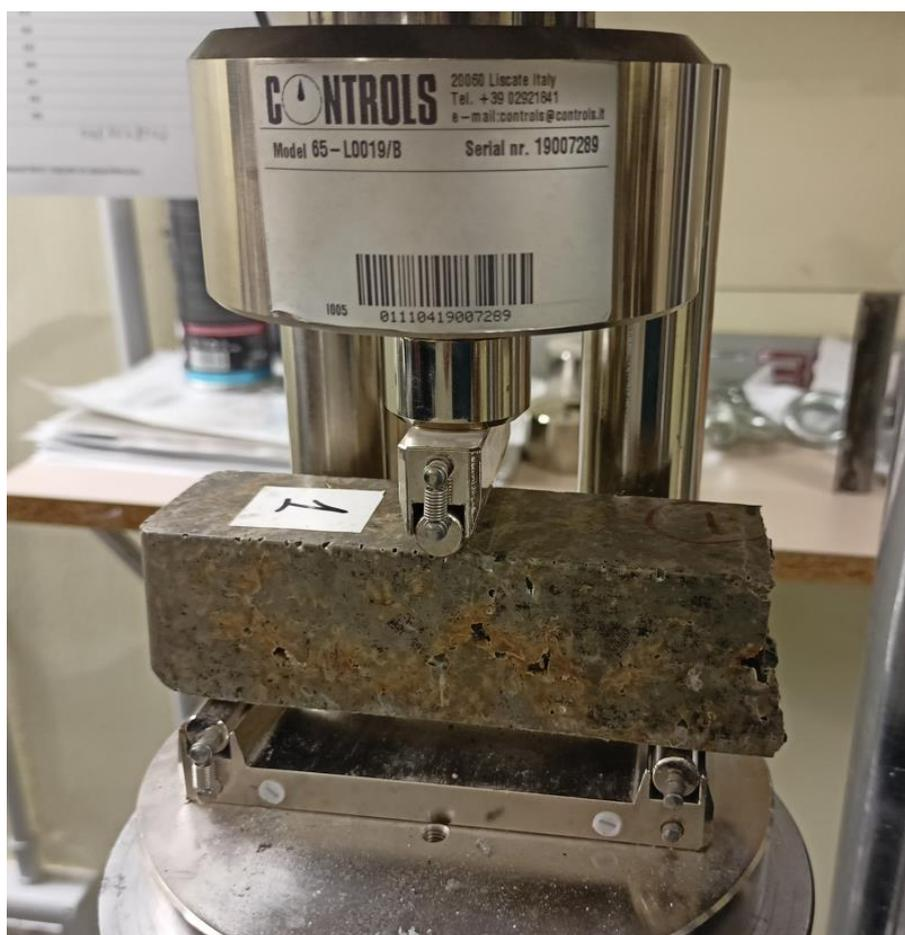
*Figura 56 - Particolare provino prova flessione su tre punti*
