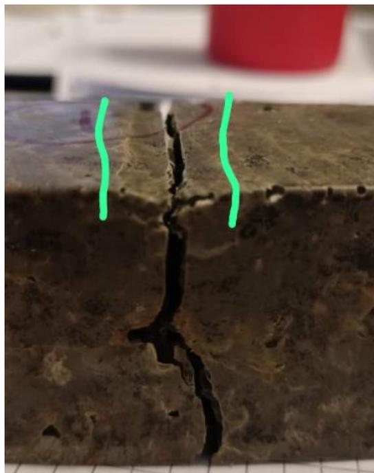
*Figura 60 – Deformazione locale dovuta alla forza puntuale applicata dalla macchina*
