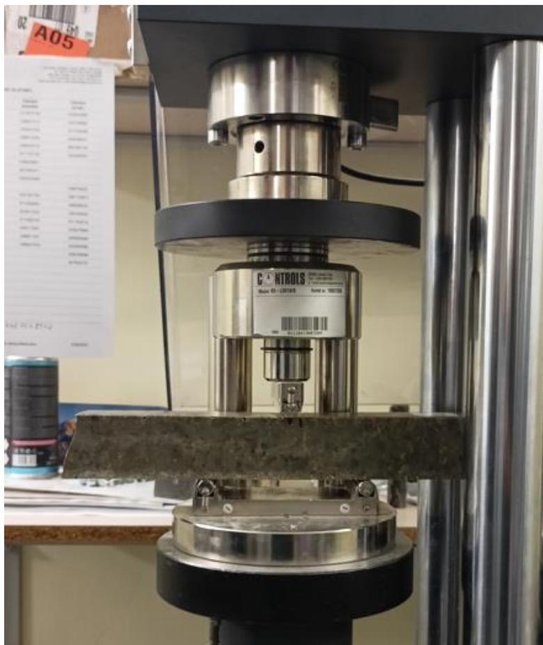
*Figura 55 – Immagine del macchinario prova di flessione su tre punti*
