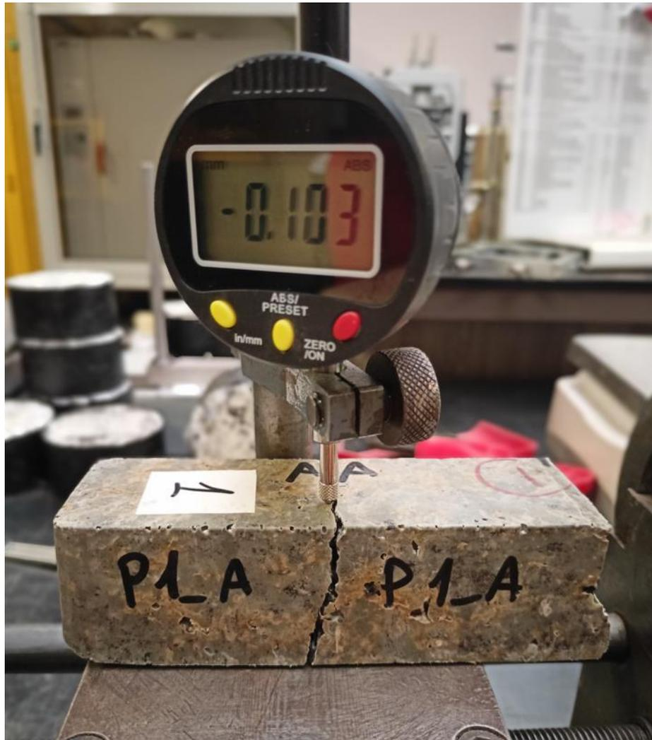
*Figura 59 - Misura della deformazione locale nel punto di contatto del carico*
