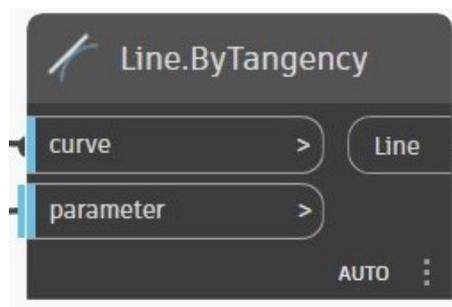
Figura 4.16 Comando per ricavare linea tangente alla curva
