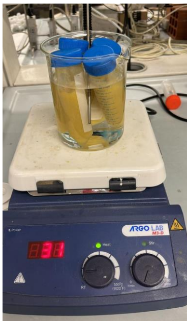
Fig 3.6 : preparazione del campione per centrifugazione a 40 °C, riscaldato su piastra.
