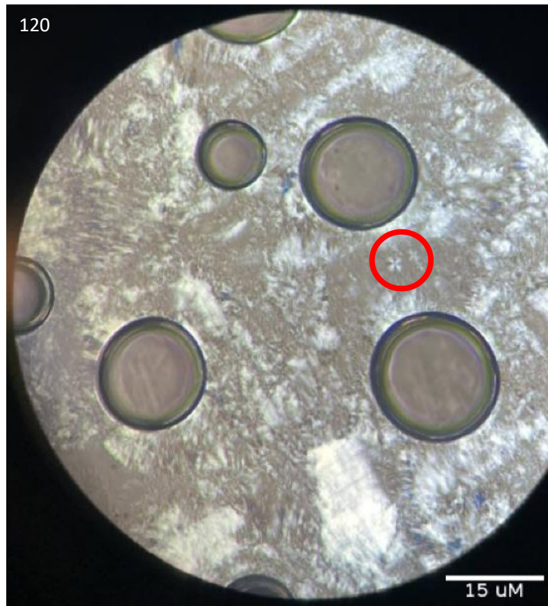
Fig. 4.5 Micrografia a luce polarizzata del C-1805 puro dopo 15 min a 120°C; obiettivo 10x.
