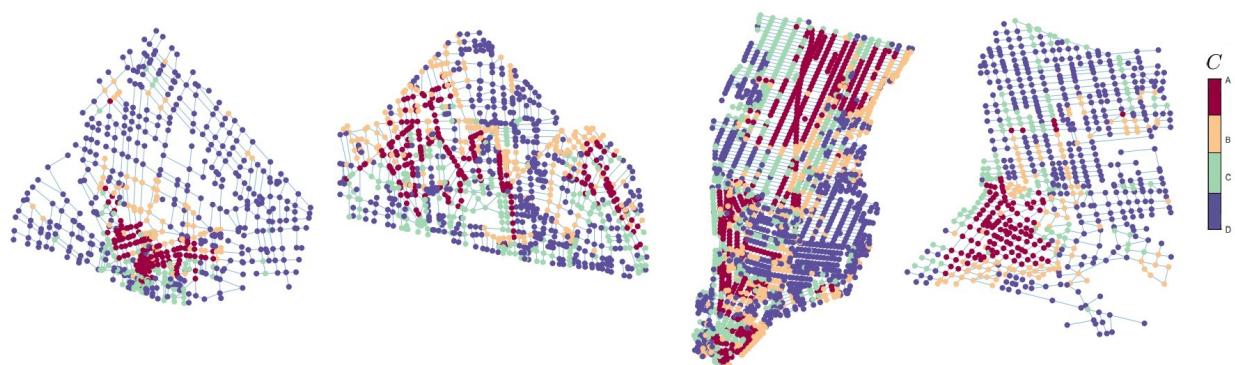
Figura 2.23: Suddivisione dei nodi in classi di vulnerabilità per una direzione del vento a 180^\circ per le città di Firenze, Parigi, New York e Lione.
