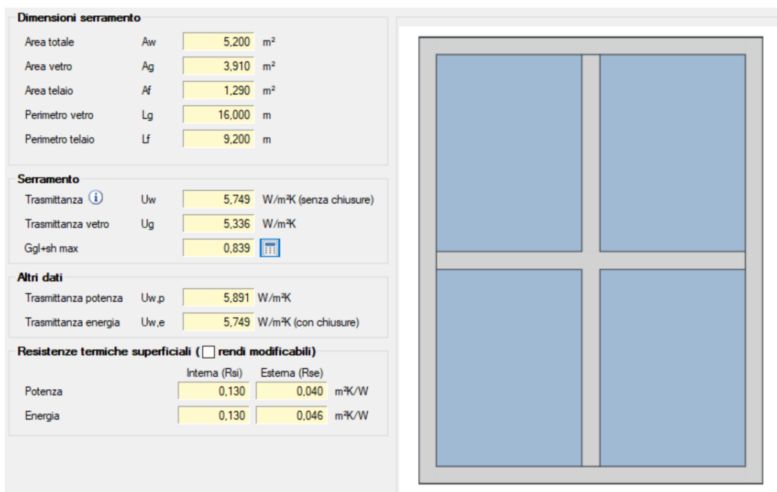
Figura 26 - Caratterizzazione dimensionale ed energetica dell'elemento finestrato W2
