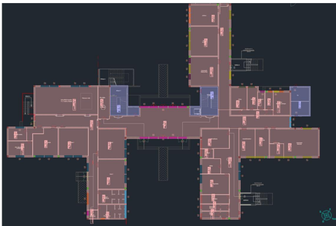
Figura 24 - Individuazione locali climatizzati e non climatizzati
