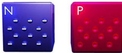
Figura 6 Tipologie di drogaggio
