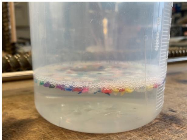
*Figura 3.48 – Processo di separazione sink-float delle scaglie di poliolefine*
