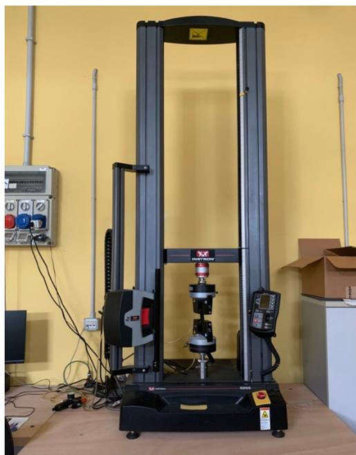
*Figura 2.20 - Dinamometro 5966 Instron*
