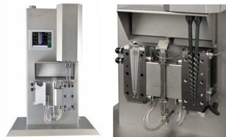
Figura 2.7 - Mini-estrusore Xplore MC 15
