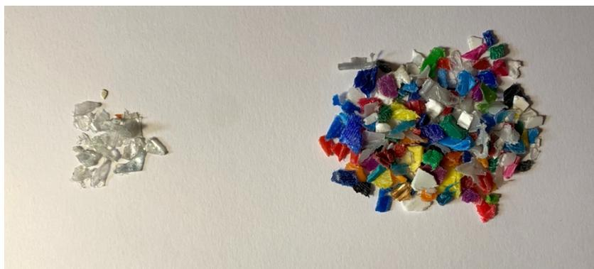
*Figura 3.49 - A destra: scaglie sink, a sinistra: scaglie float a seguito del processo di separazione*
