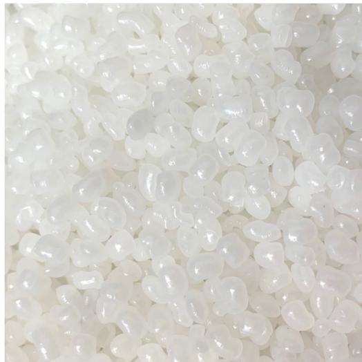
*Figura 2.3 - Pellet di PE Eraclene MS 80 U*
