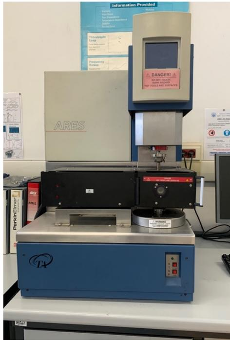
Figura 2.17 - Reometro Ares, TA Instruments
