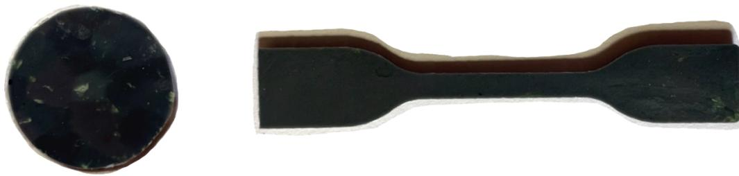
Figura 3.51 – Campione Scaglie estruse. A destra: provino per analisi reologica. A sinistra: provino per prova di trazione.
