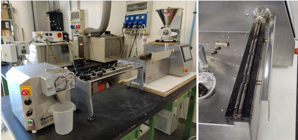
Figura 2.8 - Estrusore bivate Process 11, Thermo Fisher Scientific™. A sinistra: estrusore, vasca di raffreddamento, taglierina. A destra: viti all'interno del cilindro
