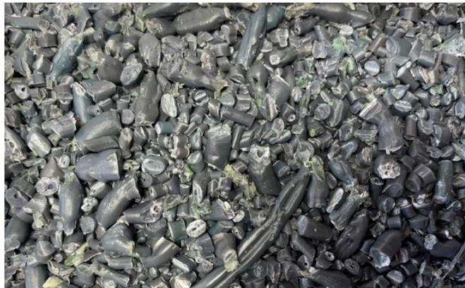
*Figura 3.47 – Scaglie tal quali lavorate in estrusore e successivamente pellettizzate*
