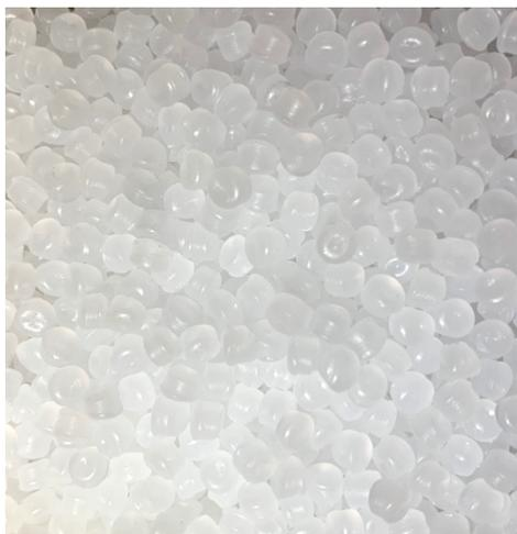
*Figura 2.5 - Pellet di Nexamite® R201*
