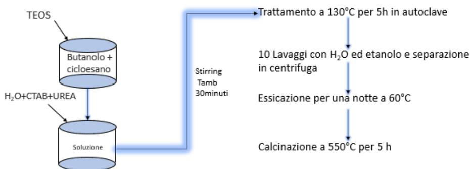
**Figura 2.2** Schema di sintesi DPS e DPS<sub>0,75</sub>
