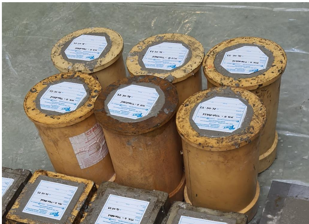
Figura 37 Provini destinati alla prova di misura del modulo elastico
