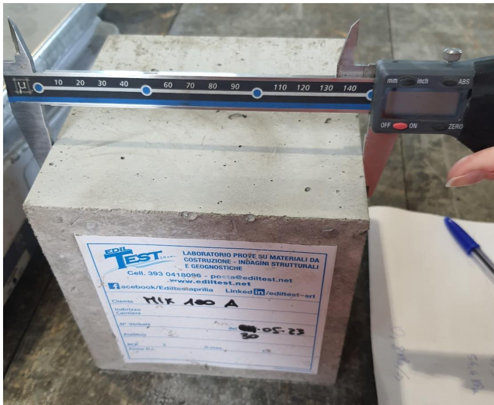
Figura 39 Misura della lunghezza del lato per la valutazione del ritiro del provino
