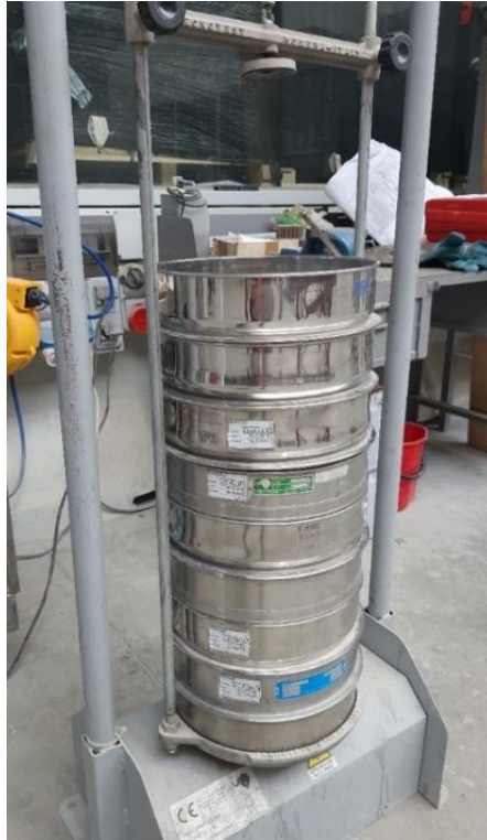
Figura 8 Struttura vibrante per la costruzione delle curve granulometriche
