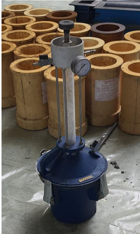
Figura 28 Strumento per la valutazione del contenuto d'aria
