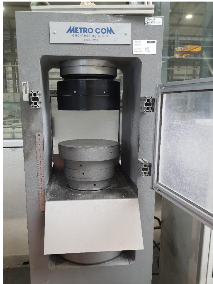
Figura 32 Macchinario per la prova di resistenza a compressione
