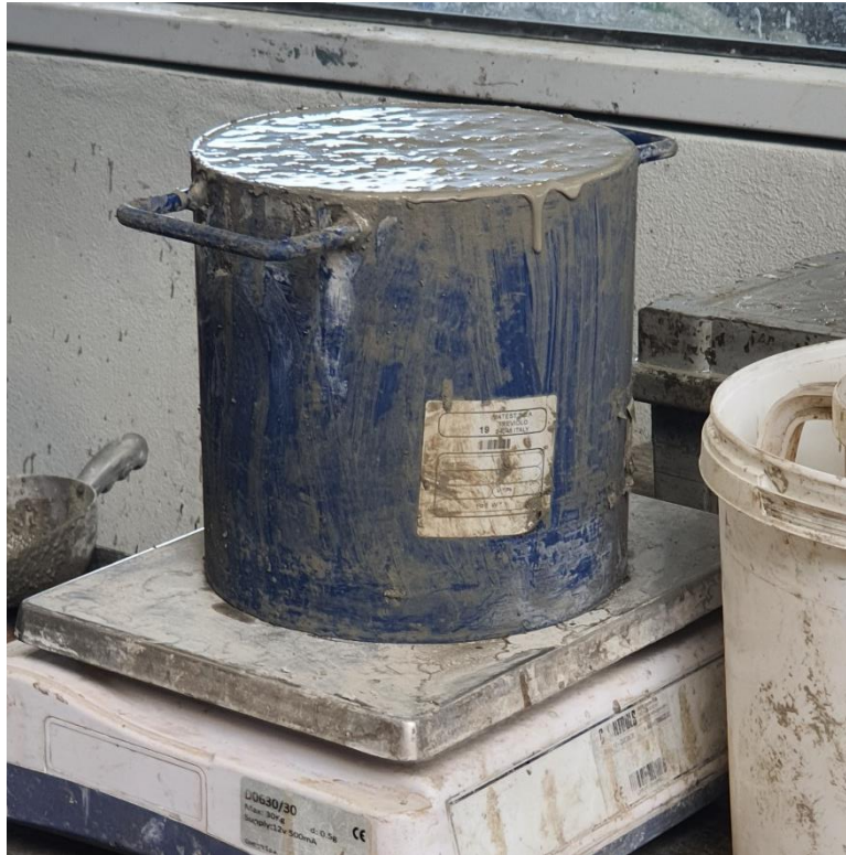
Figura 27 Prova di misura della massa volumica
