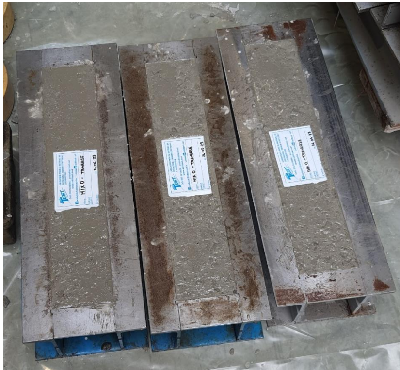
Figura 34 Set di provini destinati alla misura della resistenza a flessione
