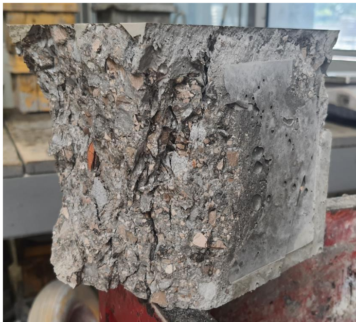
Figura 41 Rottura esempio di un provino a ventotto giorni di stagionatura
