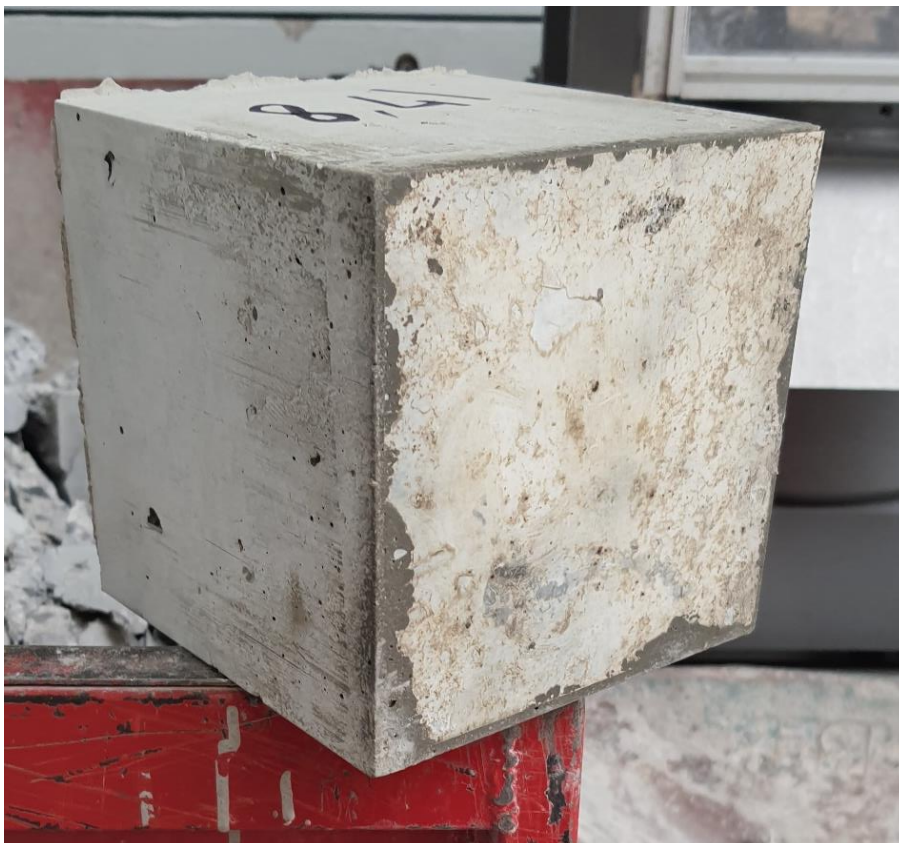
Figura 31 Provino cubico per la prova di resistenza a compressione
