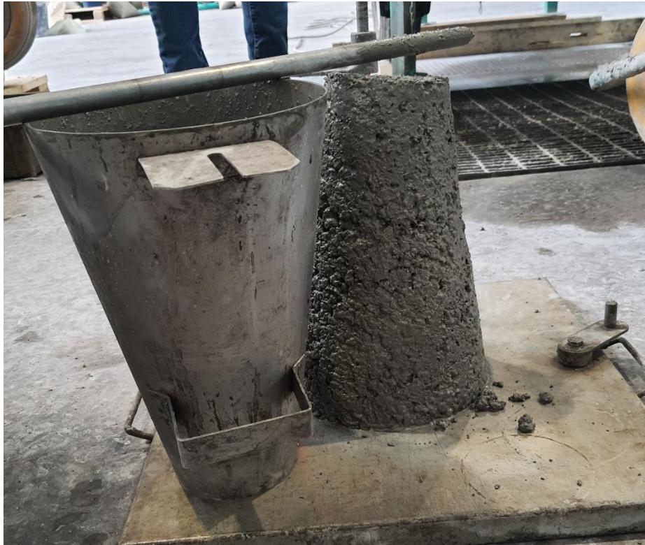
Figura 29 Slump test di calcestruzzo S1
