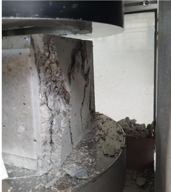
Figura 40 Rottura esempio di un provino a sette giorni di stagionatura
