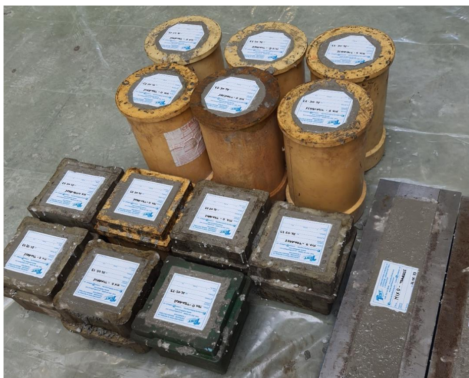
Figura 26 Provini di calcestruzzo a superficie livellata con targhetta identificativa
