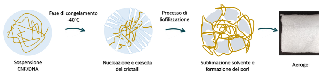
Figura 2.1 – Rappresentazione schematica del processo di congelamento e liofilizzazione
