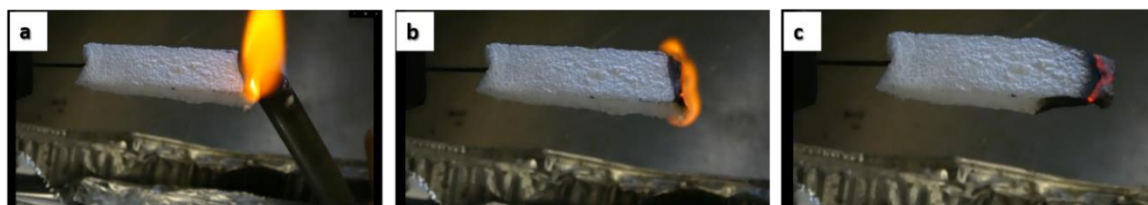
Figura 3.8 – Immagini della prova di infiammabilità UL-94 in configurazione orizzontale dell'aerogel di CNF
