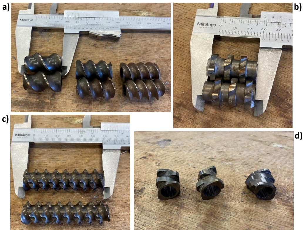
Figura 4.2: Sono riportati alcuni elementi vite utilizzati nella prova sperimentale, nello specifico: a) elementi di trasporto, b) elementi TME, c) elementi di mixing e d) elementi di masticazione.
