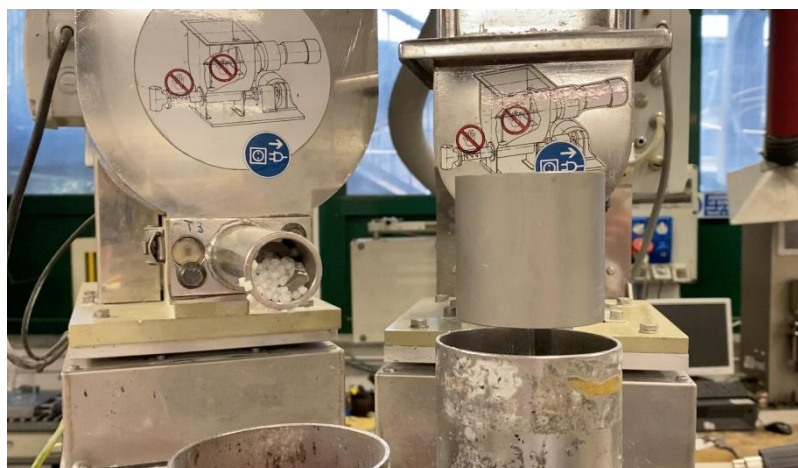
Figura 3.6: Dosatori gravimetrici per il polimero in pellet (a sinistra) e per la carica (a destra).
