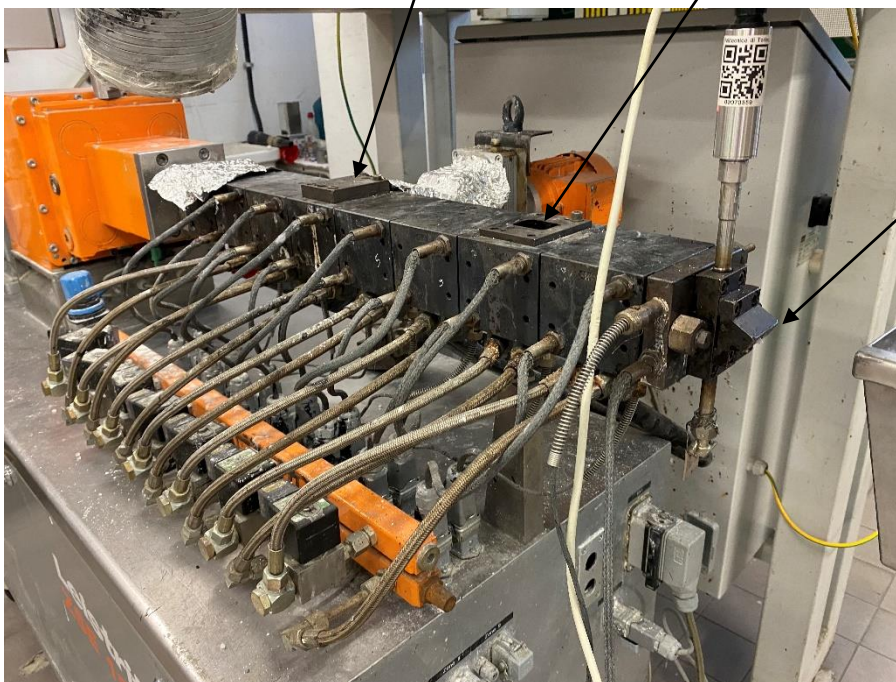
Figura 4.15: Rappresentazione delle tre zone di prelievo del materiale lungo la vite dell'estrusore. Sono riportate la zona 1 e 2 e la matrice di uscita del materiale.
