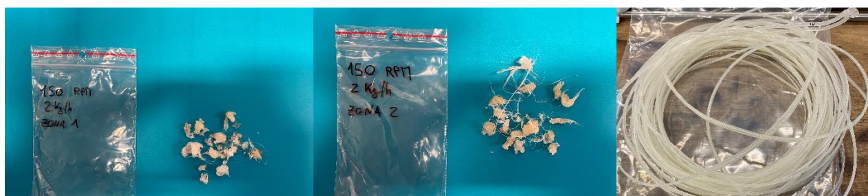
Figura 4.16: Campioni prelevati durante l'estrusione, nell'ordine si vedono Zona 1, Zona 2 e filo prelevato dalla filiera.
