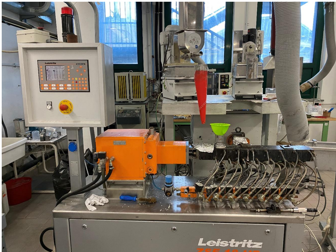
Figura 3.5: Estrusore bivate Leistritz ZSE 18 HP
