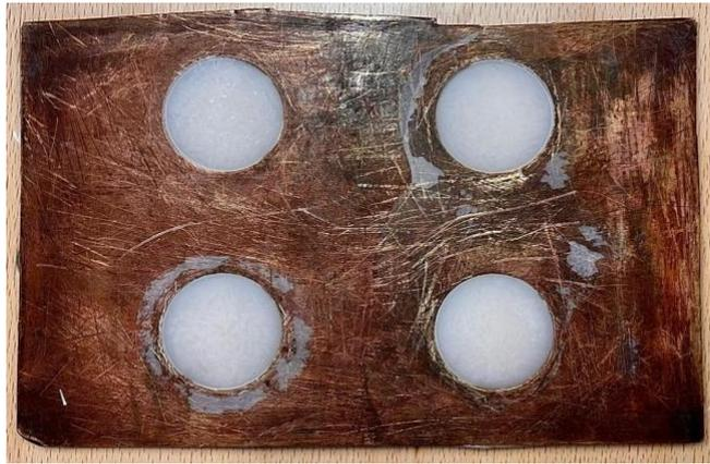
Figura 2.5 – Stampo provini per analisi reologiche
