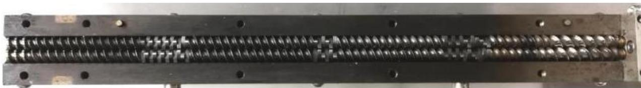
Figura 2.2 – Profilo vite estrusore bivate co-rotante Process 11
