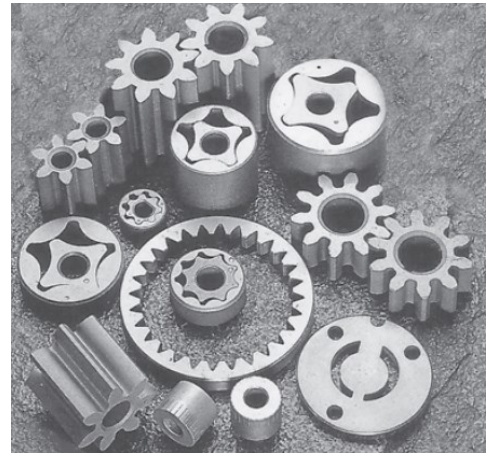
Fig. 16 – Ingranaggi di una pompa d'olio prodotta per PM [143].
