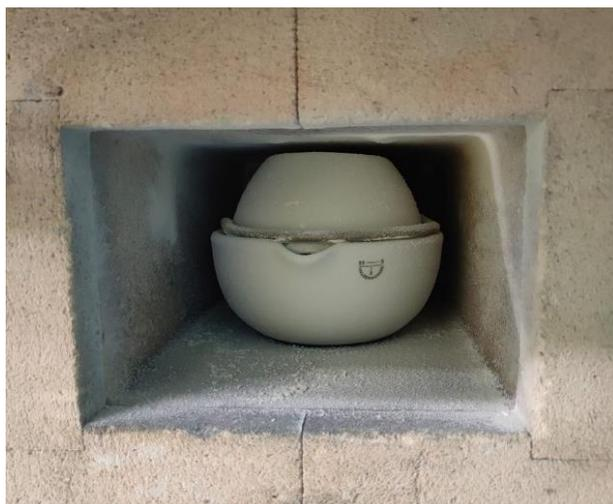
**Figura 2.1** Posizionamento del crogiolo all'interno del forno per effettuare la sintesi
