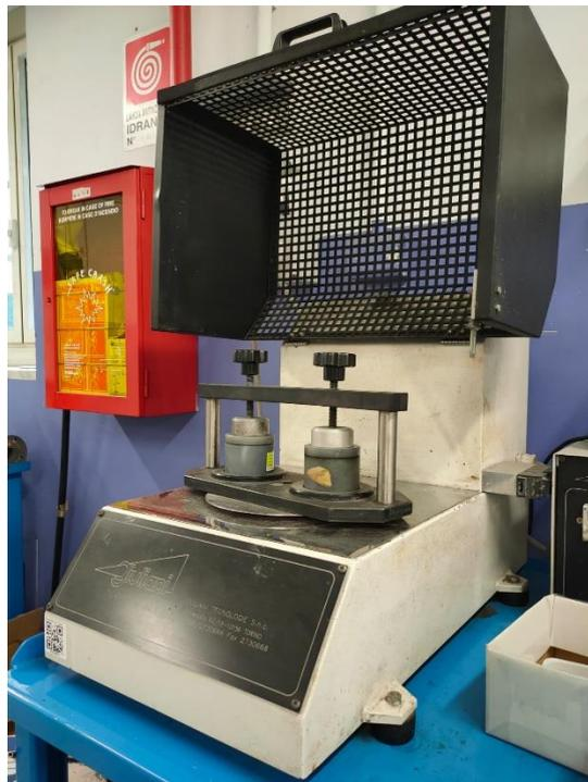
**Figura 2.9:** Mulino a sfere per realizzare il tight contact tra le fasi
