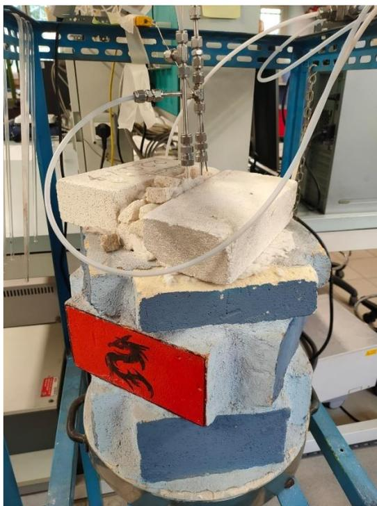
**Figura 2.8** Forno di struttura cilindrica per effettuare i test catalitici
