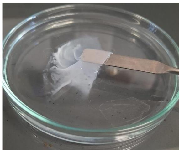
*Figura 41 Prova di reticolazione della membrana ottenuta partendo da una soluzione contenente solo PEO*
