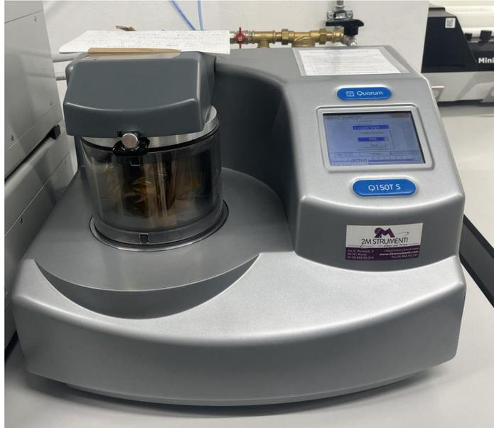
*Figura 19 Apparecchiatura usata per lo sputtering del platino*
