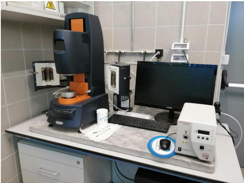
*Figura 17 Reometro impiegato per le analisi*
