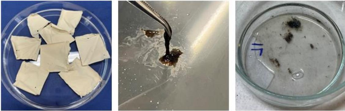
*Figura 26 Membrane prima dell'immersione in solvente (a sinistra), dopo l'immersione in DMC (in centro), e dopo l'immersione in EMI-FSI (a destra)*
