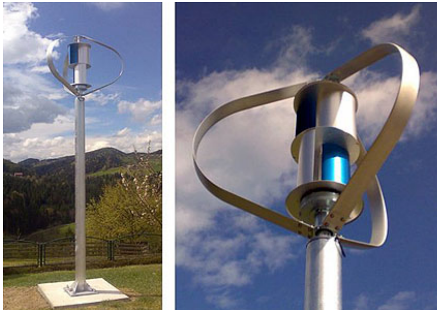
Figura 2.12 Configurazione ibrida Darrieus-Savonius
