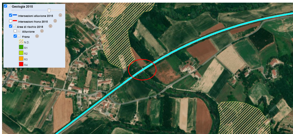
Figura 3.16: Vista satellitare tratta dall'applicazione Geologia e Idraulica: Frana
