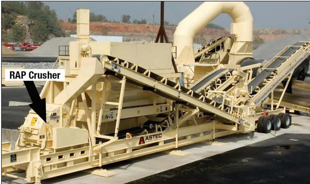
Figura 3.3.2 - Unità di elaborazione RAP con vagliatura a monte del frantoio (<https://www.asphaltpavement.org/>).
