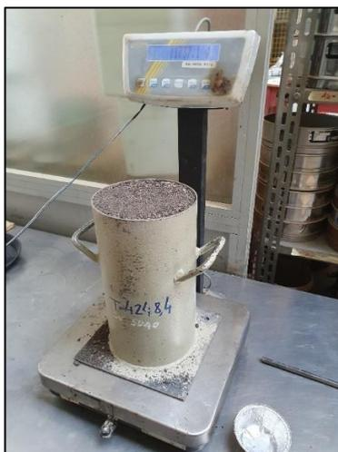
Figura 5.5.1.2 - Pesatura della ghiaia per il calcolo della densità media.
