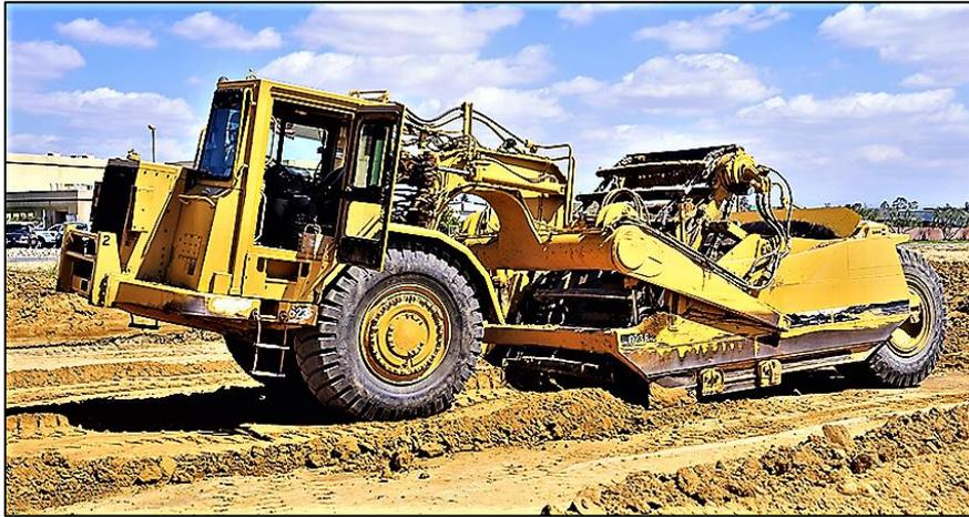
Figura 4.5.4.1 - Scraper a lavoro in un impianto di produzione (blog.iseekplant.com.au).
