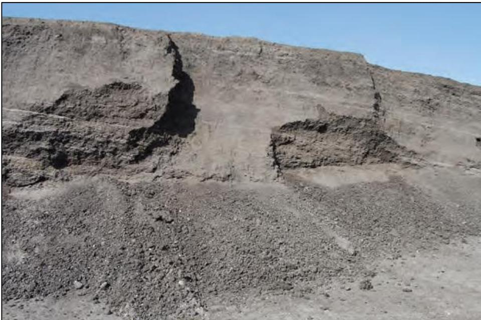
*Figura 3.2.2 - Superficie di lavoro di un cumulo di RAP, in cui sono evidenti gli strati dei materiali*
