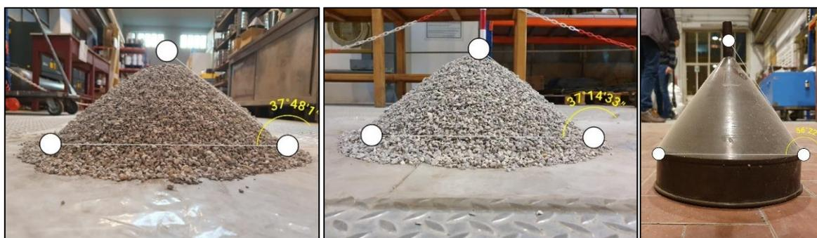
Figura 5.5.1.8 - Misurazione dell'angolo di inclinazione del cumulo di ghiaia da due differenti angolazioni. È stata aggiunta la foto di un imbuto con inclinazione nota ( $56^\circ$ ) per verificare l'affidabilità dello strumento di misurazione degli angoli tramite una APP.
