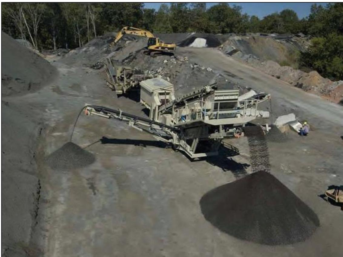
Figura 3.3.1 - Escavatore che carica il materiale in un processo di frantumazione e vagliatura del RAP (<https://www.asphaltpavement.org/>).
