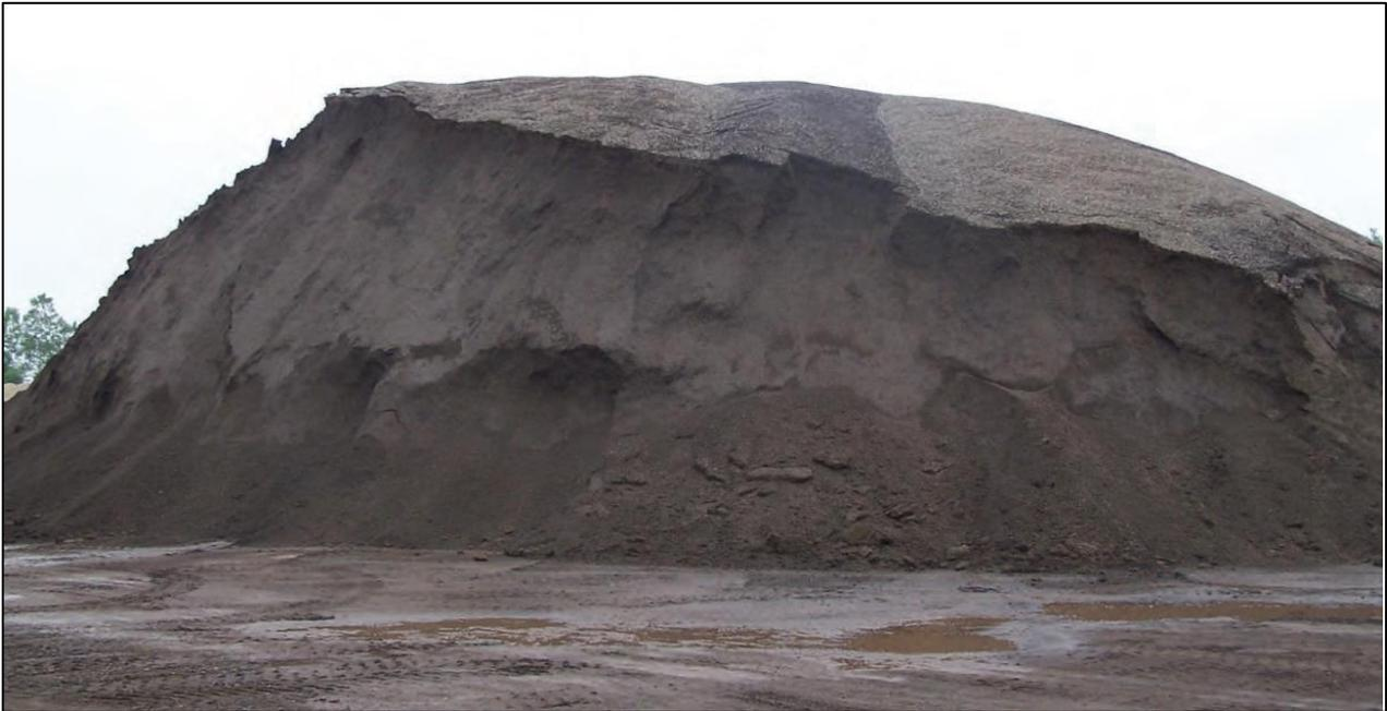
Figura 3.4.1 - RAP elaborato con un aspetto uniforme (<https://www.asphaltpavement.org/>).
