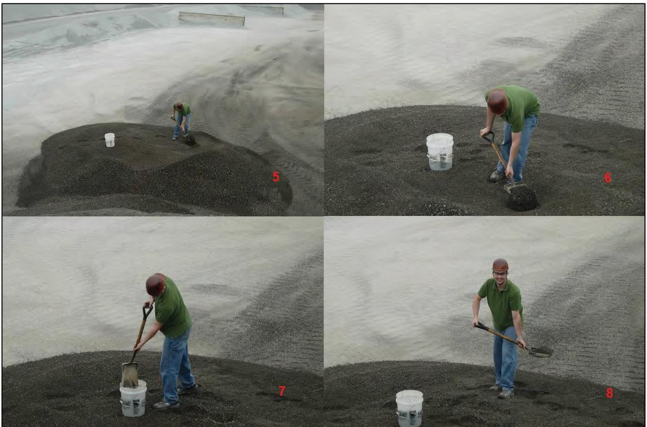
Figura 3.4.3 - Step per campionare correttamente il RAP (2, <https://www.asphaltpavement.org/>).
