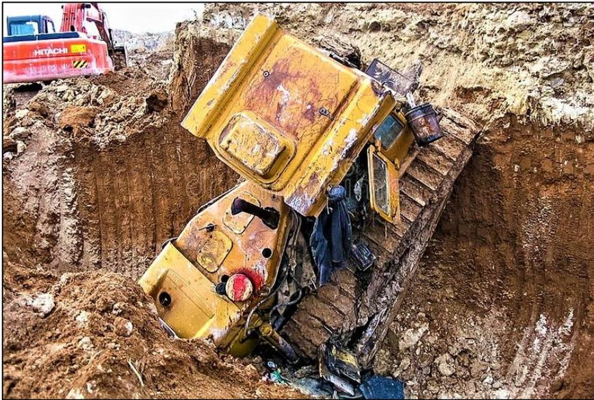
Figura 4.5.3.2 - Incidente di un dozer operante sul bordo di un cumulo (it.dreamstime.com).
