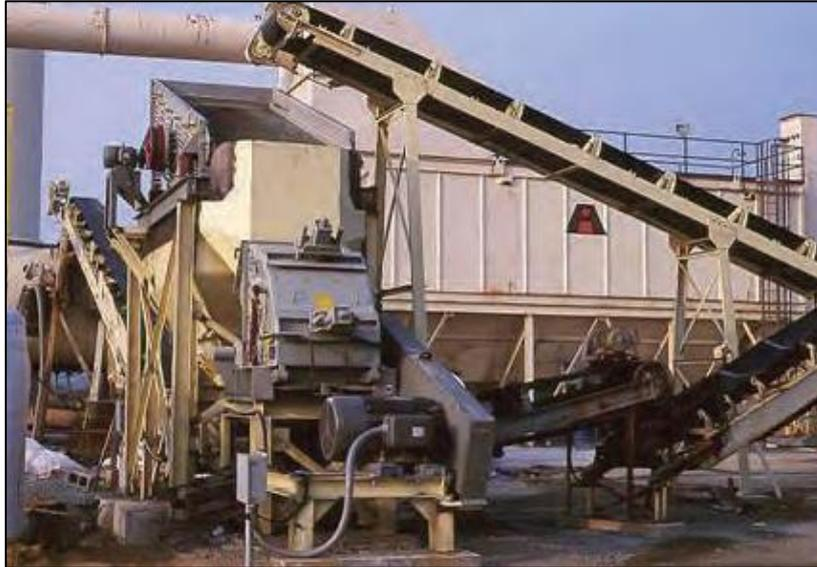
Figura 3.3.7 - Circuito di frantumazione in linea aggiunto ad un impianto per la lavorazione di materiale sovradimensionato (<https://www.asphaltpavement.org/>).
