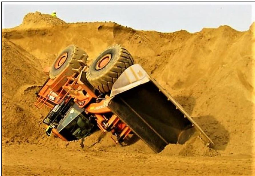
Figura 4.5.2.4 - Ribaltamento di un caricatore frontale operante sul bordo di un cumulo (constructionenquirer.com).
