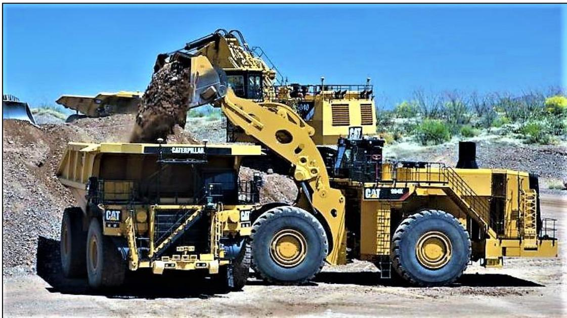
Figura 4.5.2.2 - Caricatore frontale scarica materiale sul dumper, prestando attenzione intorno al loro raggio d'azione (mining.com).
