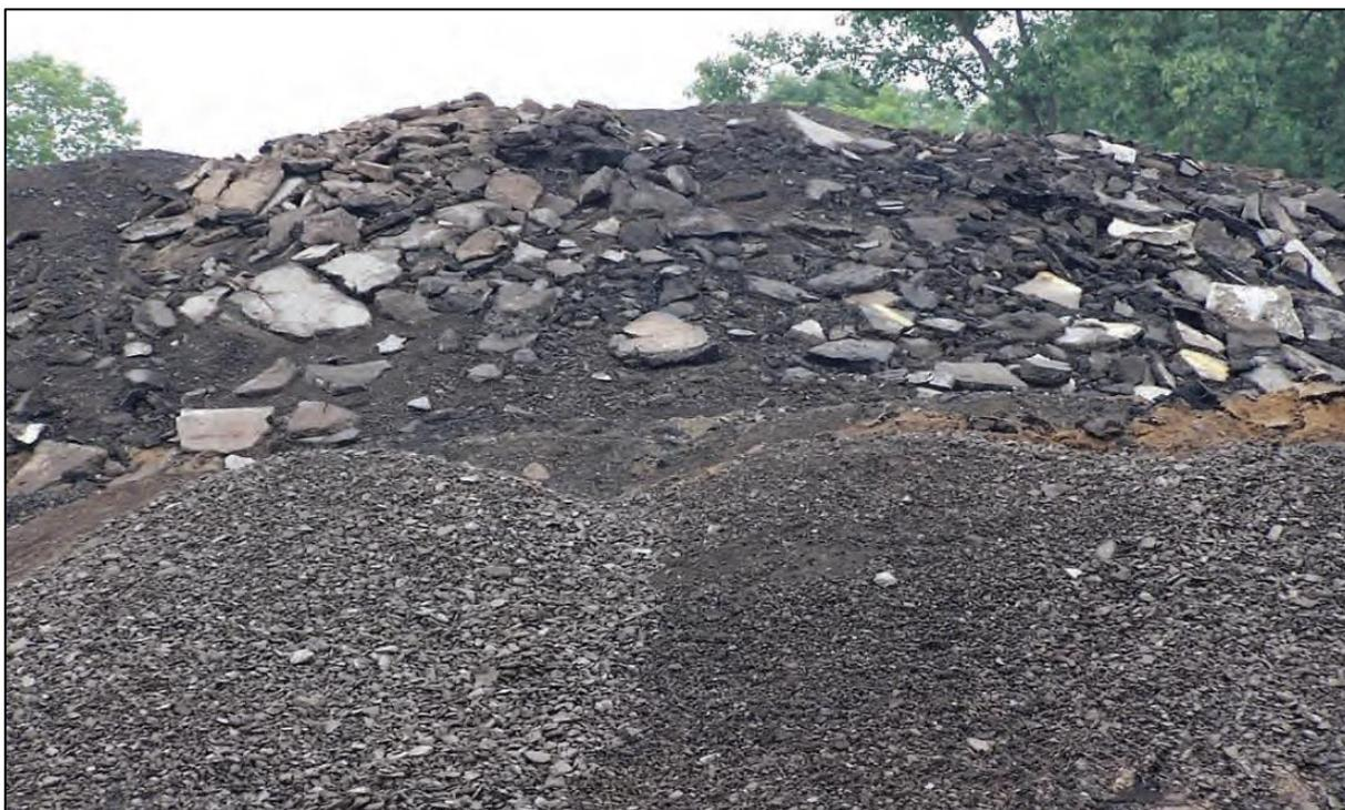
Figura 3.1.4 - Cumulo di RAP proveniente da più fonti con presenza di contaminanti (<https://www.asphaltpavement.org/>).
