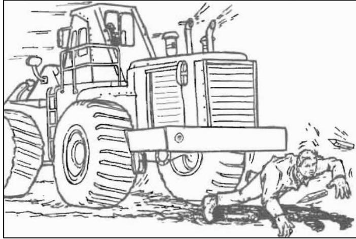
*Figura 4.5.5.2 - I lavoratori a piedi devono stare attenti agli allarmi di backup ed essere pronti a muoversi in fretta se necessario (Stockpiling Safety, U.S. Department of Labor).*
