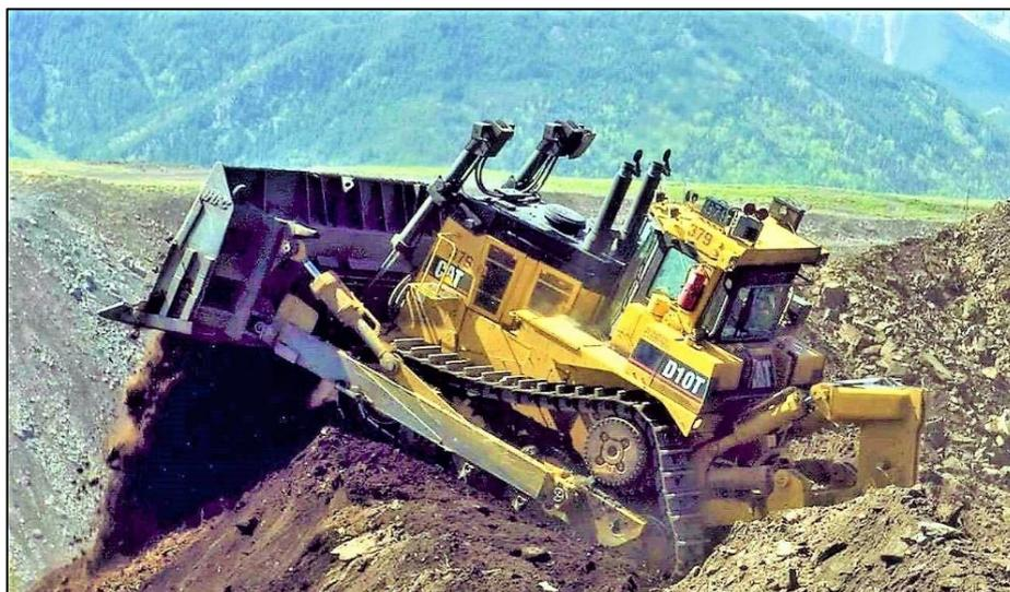
Figura 4.5.3.1 - Dozer in azione perpendicolarmente al bordo del pendio (wvrecord.com).
