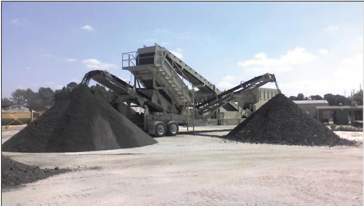
Figura 3.3.5 - Cumuli di RAP di dimensioni differenti (a sinistra di dimensione 3/16", ossia 0,48 cm, e a destra di 3/4", ossia 1,91 cm) (<https://www.asphaltpavement.org/>).
