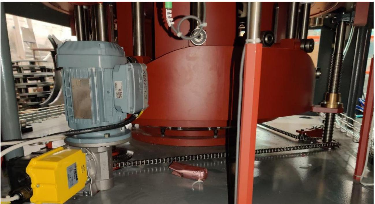
*Figura 92 - camma 1 della colonna di centraggio*
