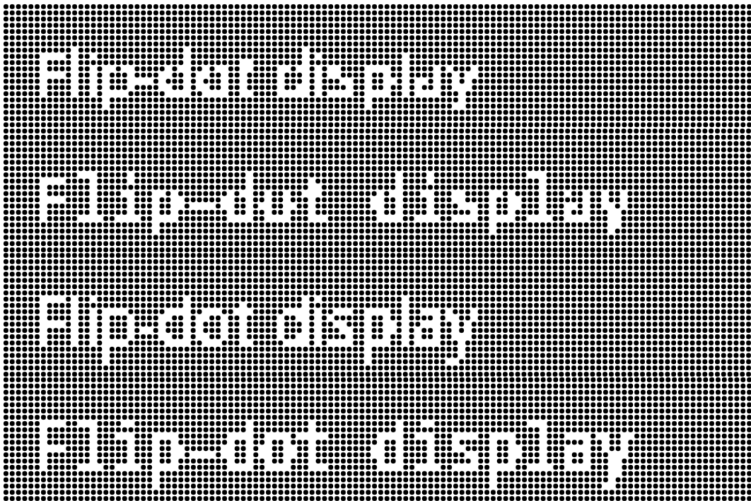
Figura 45. Confronto tra simulazioni di testi disegnati su un display flip-dot al variare delle impostazioni di grid-fitting e monospacing
