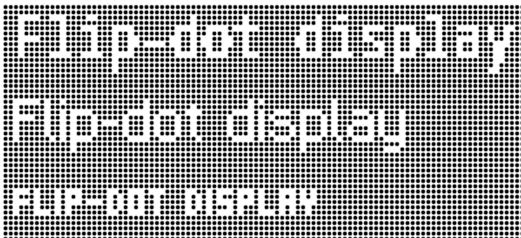
Figura 48. Confronto tra il carattere Noto Sans Monospace con grid-fitting e due tipologie di carattere personalizzate
