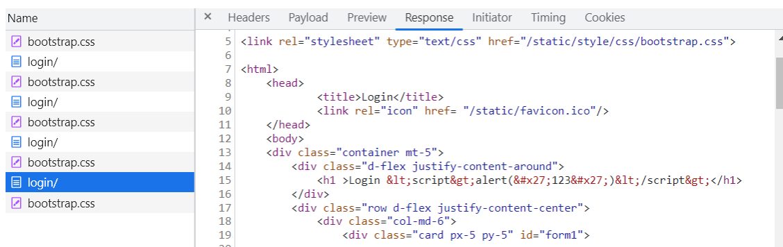
Figura 6.6. Risposta del server con input sanificato alla riga 15
