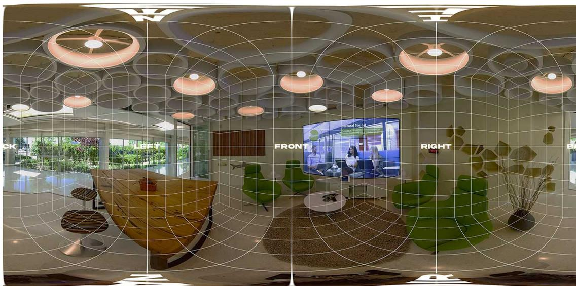
**Figura 3.18:** Proiezione equirettangolare di un frame sferico: il nord corrisponde alla porzione "FRONT" [35]
