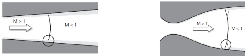
Figura 1.9: Interazione urto-strato limite in un diffusore a sinistra (a); Interazione urto-strato limite in un ugello a destra (b) (6).
