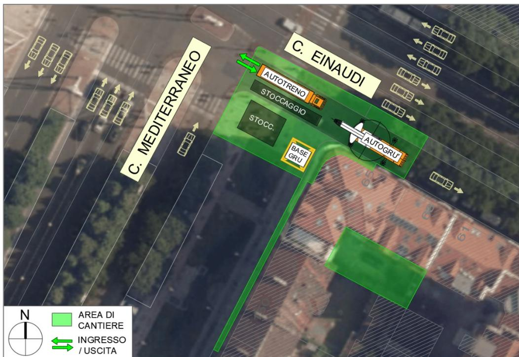
Figura 56 - Configurazione del cantiere su corso Einaudi
