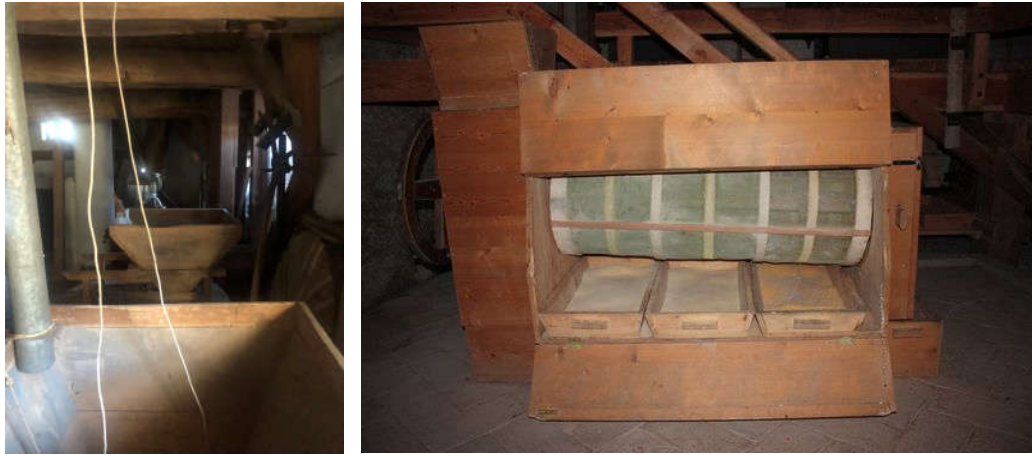
Figura 10: Da sinistra, tramoggia e cordino del sistema “uccellino”; buratto con cilindro interno. (Fonte: foto dell'autore; https://tuttoin1.it/buratto-macchina-antica-setacciare/ ).
