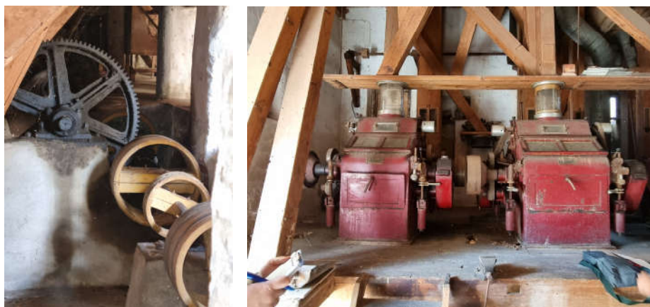
Figura 37: Da sinistra ingranaggi posti sotto il castelletto; laminatoi cilindrici BLANC.
