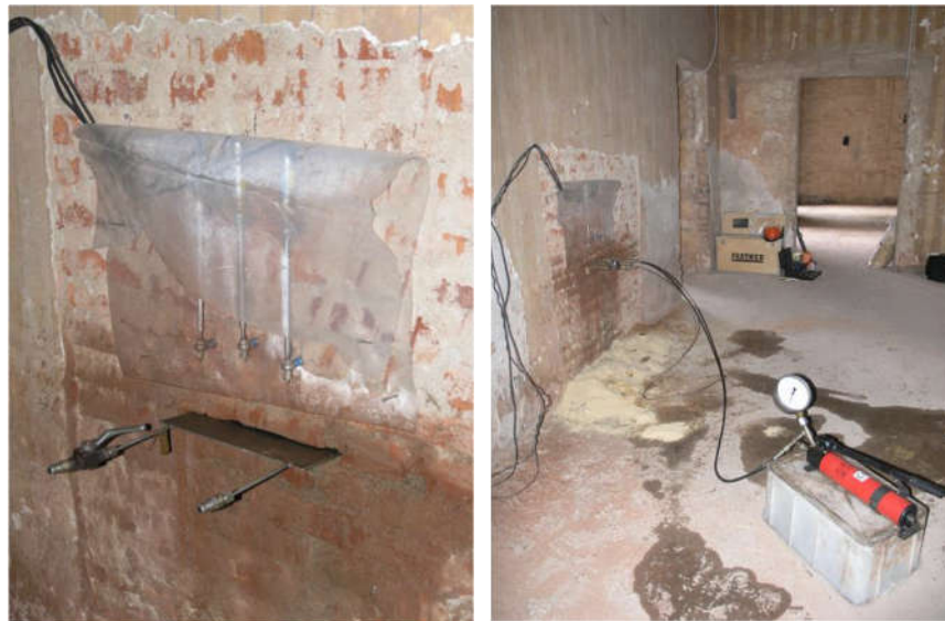
Figura 31: Martinetti inseriti nella muratura e pompaggio dell'olio in pressione per la determinazione della tensione di esercizio agente (Fonte: Ing. Grazzini).
