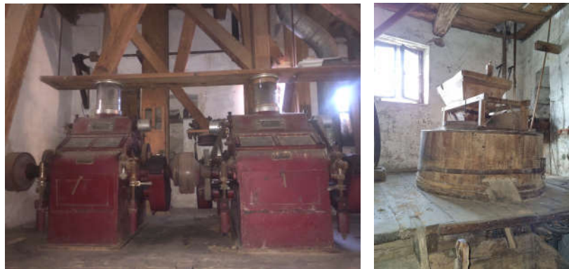
Figura 03: Da sinistra, laminatoi cilindrici della ditta BLANC; macine antiche con tramoggia in legno.
