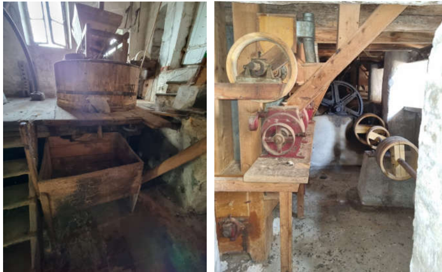
Figura 09: Da sinistra, tramoggia e macina poste sul castello che le sorregge; ingranaggi e elementi di trasmissione del moto posti al di sotto del castello.
