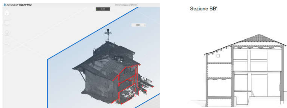
Figura 35: Esempio di elaborazione della nuvola di punti del mulino Querio con il software Autodesk Recap. In questo caso, si confrontano le discrepanze tra una sezione da rilievo con laser scanner e un elaborato ottenuto da documenti catastali e elaborati in formato .dwg. (Fonte: elaborazione personale).
