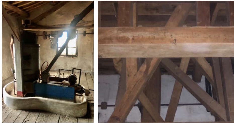
Figura 12: Da sinistra, sistema di lavaggio dei cereali nel mulino Querio, con pompa di adduzione d'acqua e vasca di raccolta; sistema di trasporto dei semilavorati che attraversano tutta la struttura del mulino, in alcuni punti con coppelle.
