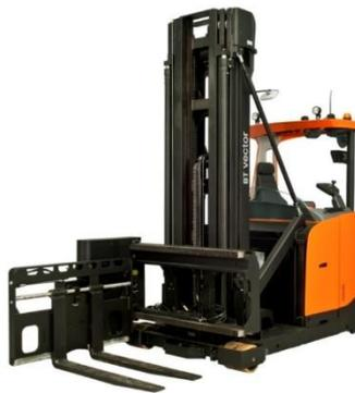
Figura 1.9 - Carrello a presa laterale<sup>[38]</sup>
