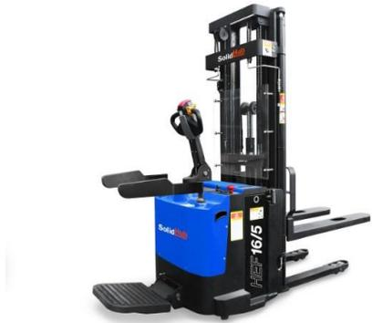
Figura 1.6 - Transpallet elevatore [32]
