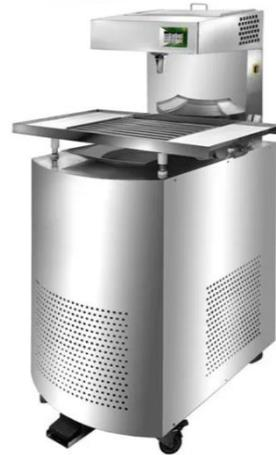
*Figura 2.52: Esempio di una macchina per il temperaggio del cioccolato usata sulla linea "Linea 9"*
