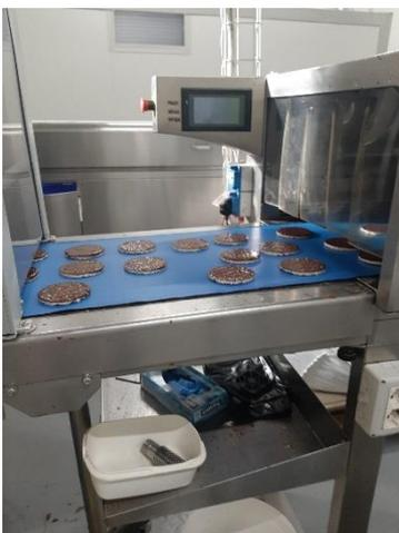
*Figura 2.55: Esempio di ingresso delle gallette ricoperte di cioccolato nel tunnel di raffreddamento*
