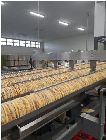
Figura 2.28: Quattro canali vibranti linea "Linea 3"
