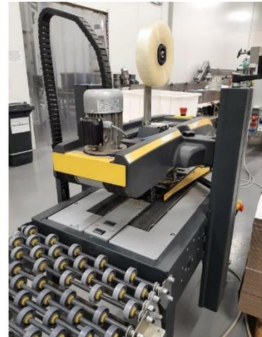
Figura 2.20: Esempio di una nastratrice semiautomatica usata in Cereal Food S.r.l.
