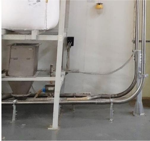
*Figura 2.61: Tubazione doppia dei big bag delle linee "Linea 1" e "Linea 3" nella parte inferiore*
