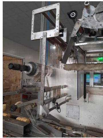
Figura 2.15: Srotolamento del film plastico per il confezionamento linea "Linea 1"
