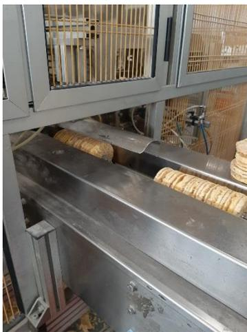
Figura 2.14: Porzionamento volumetrico delle gallette linea "Linea 1"
