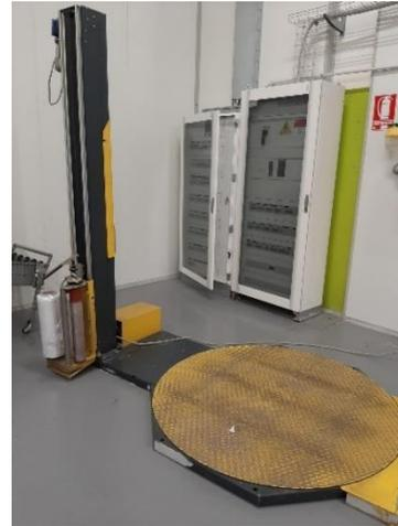
Figura 2.22: Esempio di un fasciapallet con tavola rotante usato in Cereal Food S.r.l.
