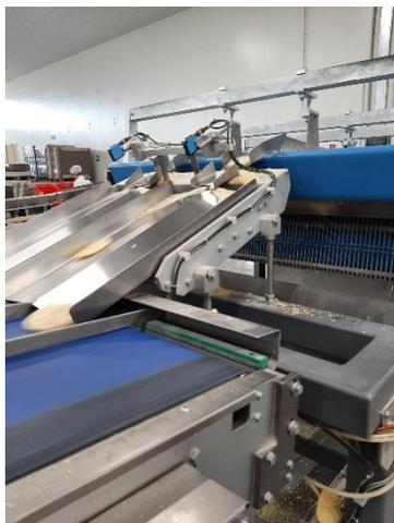
Figura 2.26: Scivolo metallico linea "Linea 3" con fotocellule
