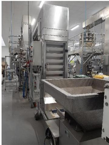
Figura 2.43: Tramoggia vibrante e nastro trasportatore a tazze linea “Linea 5”
