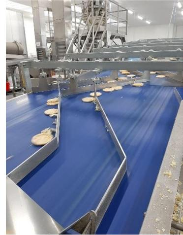
Figura 2.25: Convogliatori metallici linea "Linea 3" che creano due canali
