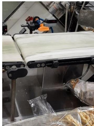
*Figura 2.17: Soffio d'aria che scarta le confezioni non conformi nei passaggi nel metal detector e sulla bilancia linea "Linea 1"*
