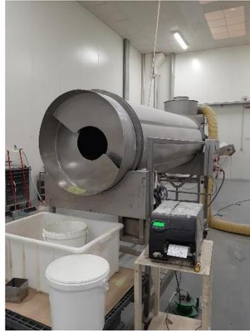
Figura 2.46: Cilindro rotante usato per il confezionamento dei pellet linea "Linea 6"
