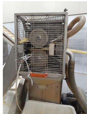
Figura 2.48: Fase di taglio del tubo di prodotto estruso linea "Linea 6"
