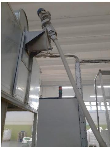
Figura 2.8: Tubo convogliatore con coclea interna linea "Linea 1"
