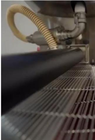
*Figura 2.53: Esempio di un tubo per far fluire il cioccolato sotto la griglia di colatura*
