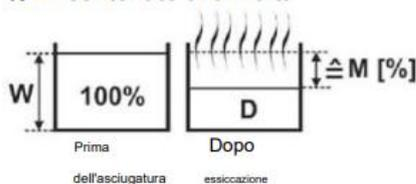
Figura 3.3: Illustrazione della perdita di umidità durante l'analisi termogravimetrica
