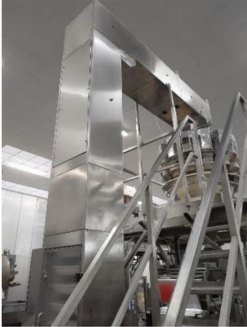
Figura 2.38: Percorso verso l'alto del nastro elevatore a tazze linea "Linea 4"
