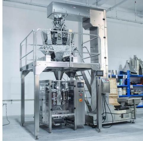
Figura 2.39: Esempio di una struttura composta dalla pesatrice multiteste e dalla confezionatrice verticale
