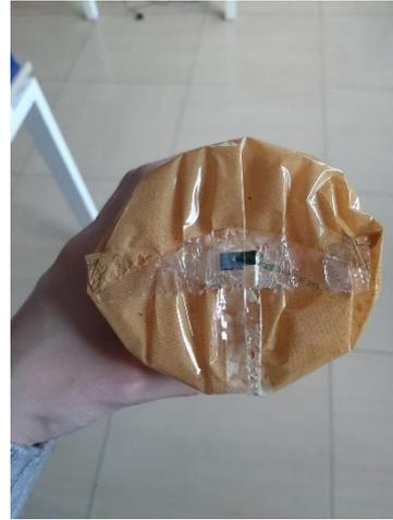
Figura 2.31: Parte inferiore della confezione di tipo flow-pack
