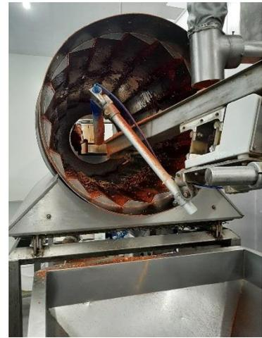
Figura 2.44: Aromatizzatore a tamburo linea “Linea 5”
