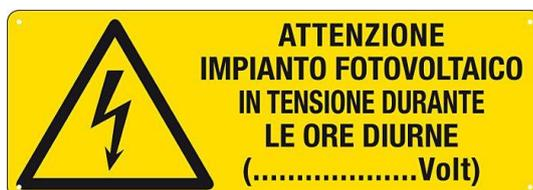
Figura 2-11: Segnaletica di sicurezza per impianti fotovoltaici. [21]
