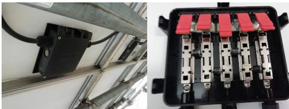
Figura 1-17: Scatola di giunzione sul retro di un modulo fotovoltaico (sinistra) e interno di una scatola di giunzione, con 4 diodi di bypass (destra).
