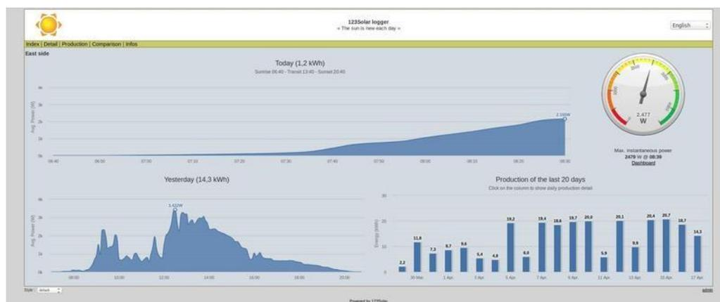
Figura 3-8: Esempio di schermata principale dell'interfaccia web di 123Solar. [23]
