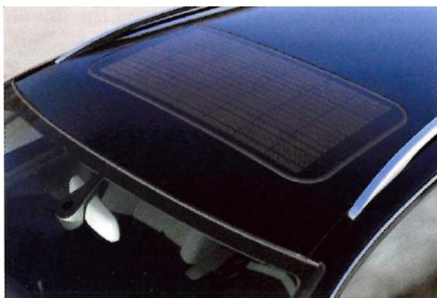
Figura 1-21: Modulo FV integrato sul tetto di un'automobile. [1]
